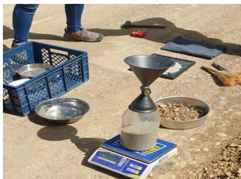
Figura 42. Verificación con el ensayo de cono de arena.
