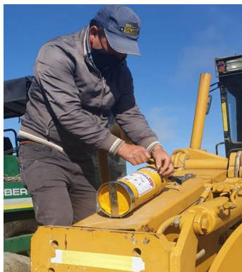
Figura 49. Instalación de un extintor en la motoniveladora.
