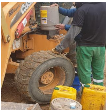
Figura 47. Supervisión del llenado de la maquinaria con ACPM.
