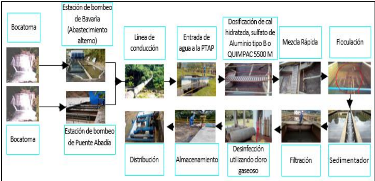
Anexo 6 Proceso de Potabilización del agua en la PTAP La Esmeralda de la EAAV-ESP, por Mendoza I, Vanegas T, 2019.
