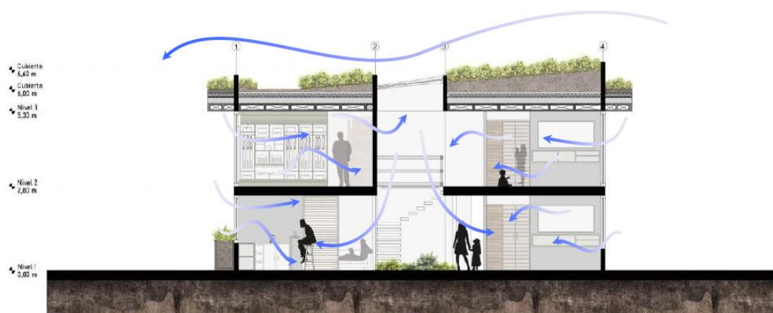
Figura 161. Cortes Bioclimático Ventilación A-A. Tipología C
