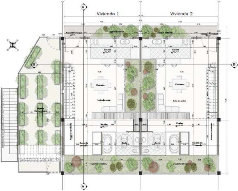
Figura 118. Planta arquitectónica Nivel 2 – Tipología A
