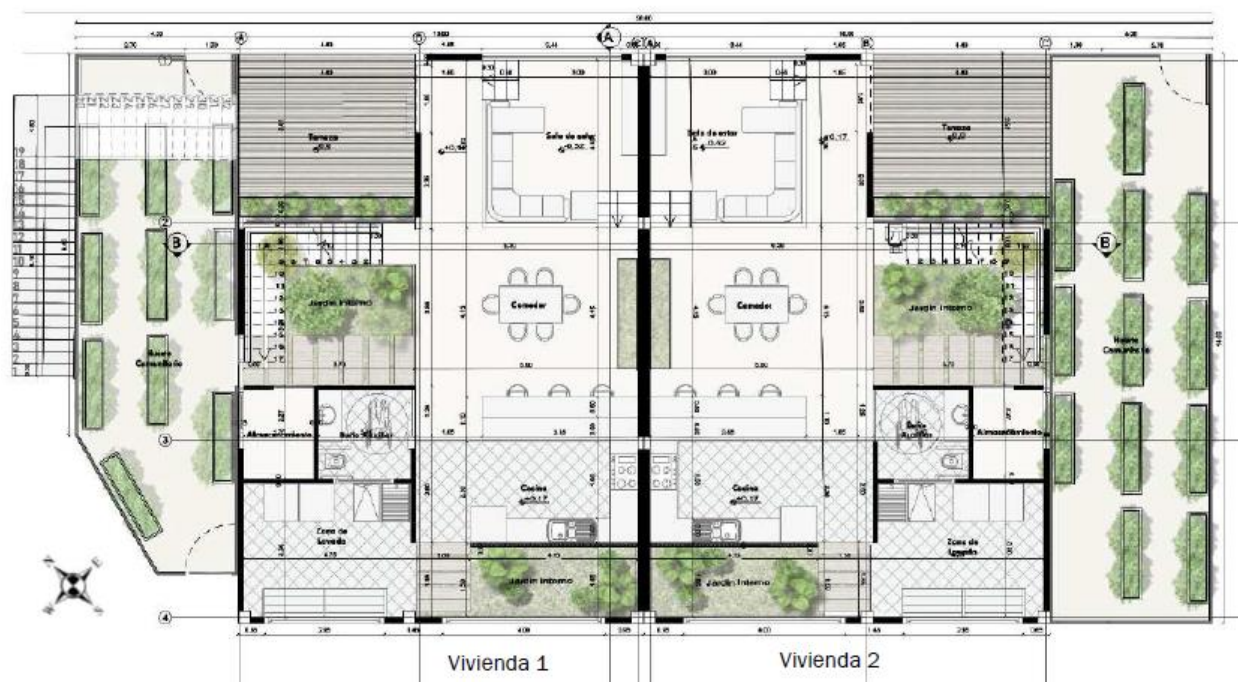
Figura 134. Planta arquitectónica primer nivel – Tipología B
