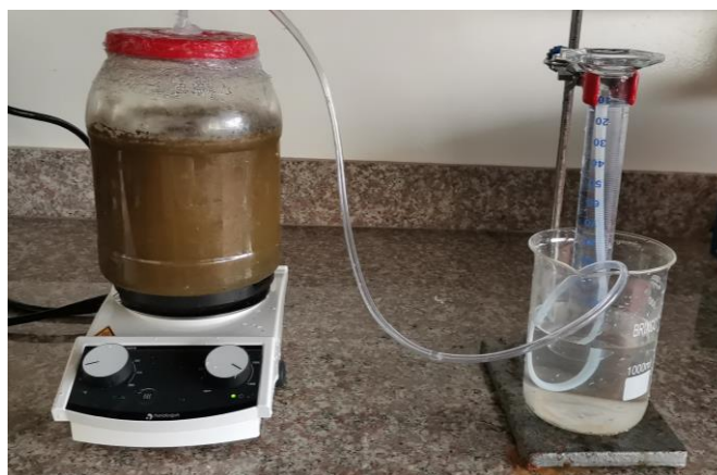
Figura 14. Montaje de medición de desplazamiento de biogás. Por: Quijano y Ramirez 2020.
