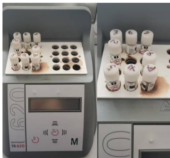
Figura 6. Tubos en termoreactor para pruebas de DQO y nitrógeno total. Por: Quijano & Ramirez 2020.
