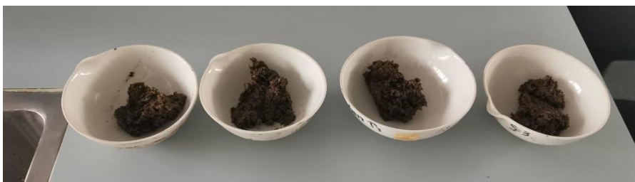
Figura 3. Montaje para la determinación de sólidos totales de las excretas. Por: Quijano & Ramirez 2020.
