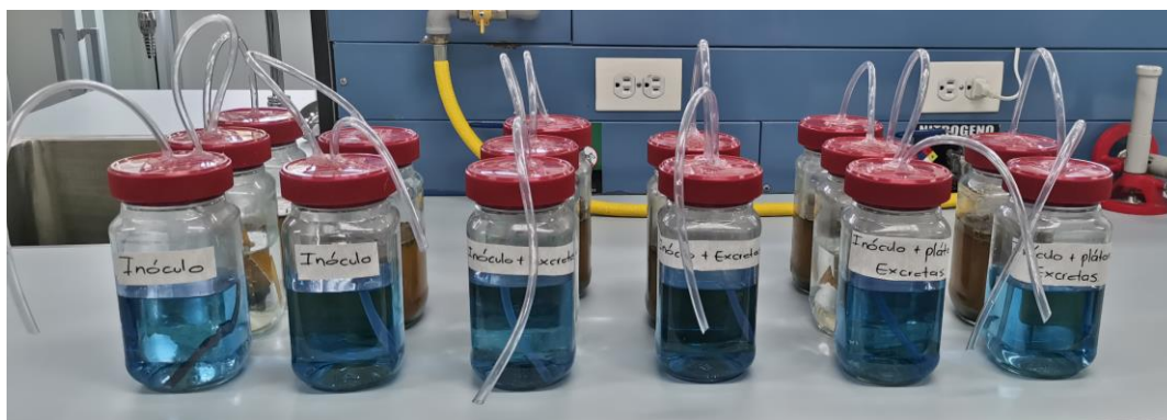
Figura 7. Montaje experimental para la determinación de biogás y metano a escala de laboratorio en microreactores tipo batch. Por: Quijano & Ramirez 2020
