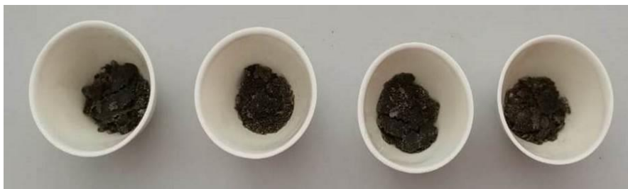
Figura 4. Montaje para la determinación de sólidos volátiles del inóculo, después de 505 °C. Por: Quijano & Ramirez 2020.
