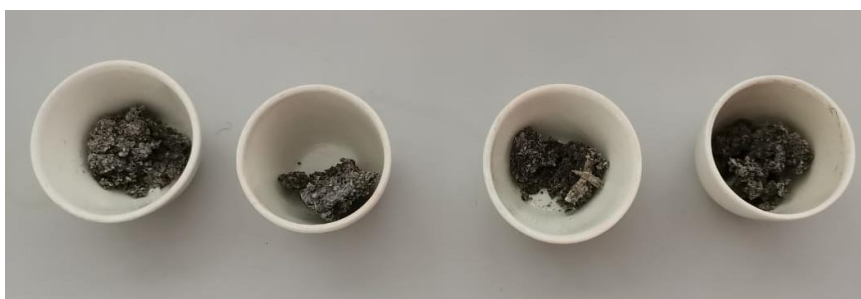
Figura 5. Montaje de sólidos volátiles de las excretas, después de 505 °C. Por: Quijano & Ramirez 2020
