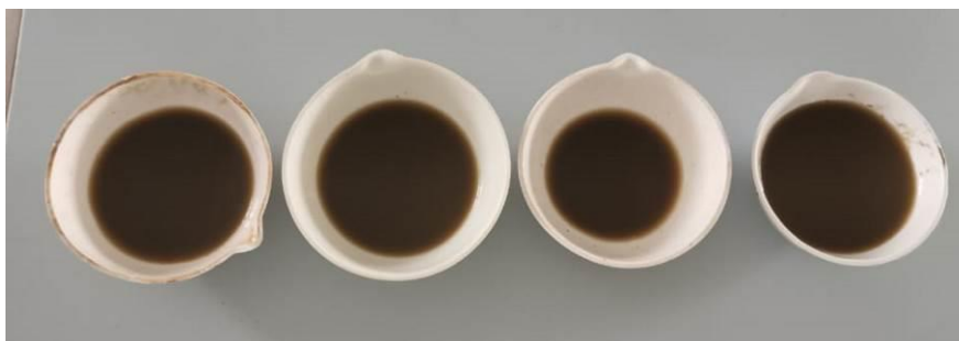
Figura 2. Montaje para la determinación de sólidos totales del inóculo. Por: Quijano & Ramirez 2020.
