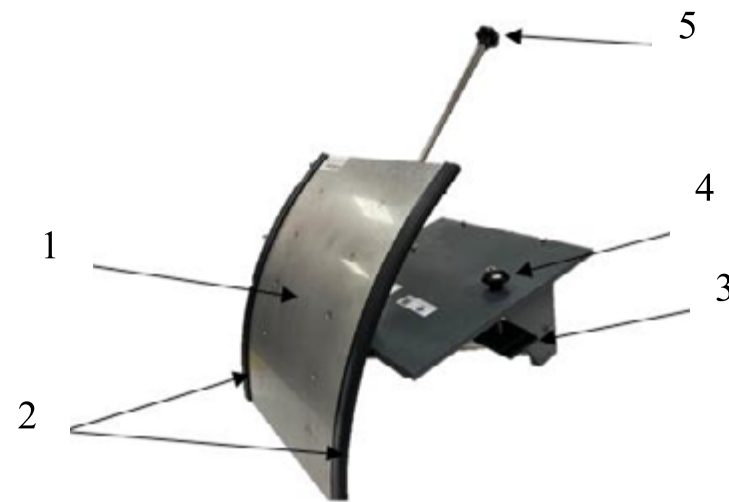
Imagen 30. Compuerta de segmento. Fuente: Elaboración propia.
