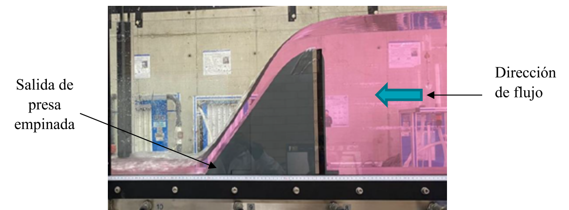
Imagen 132. Salida empinada de una presa. Fuente: Elaboración propia.
