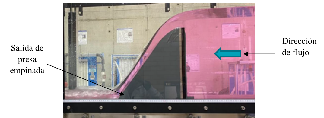
Imagen 120. Salida empinada de una presa. Fuente: Elaboración propia.
