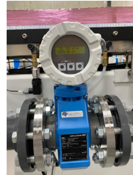
Imagen 31. Caudalímetro. Fuente: Elaboración propia.
