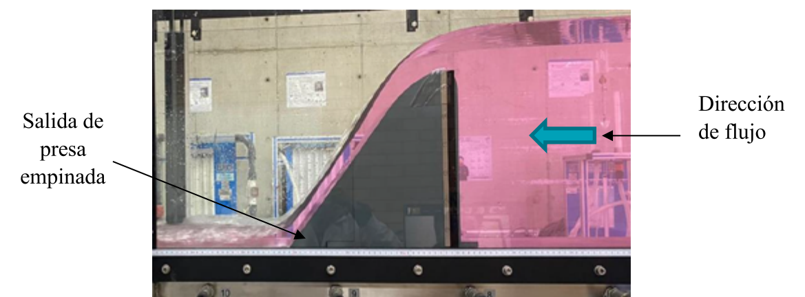
Imagen 144. Salida empinada de una presa. Fuente: Elaboración propia.
