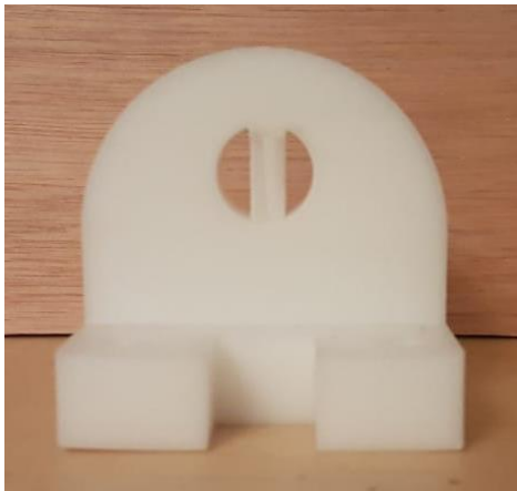
Figura 17. Pieza con exceso de material
