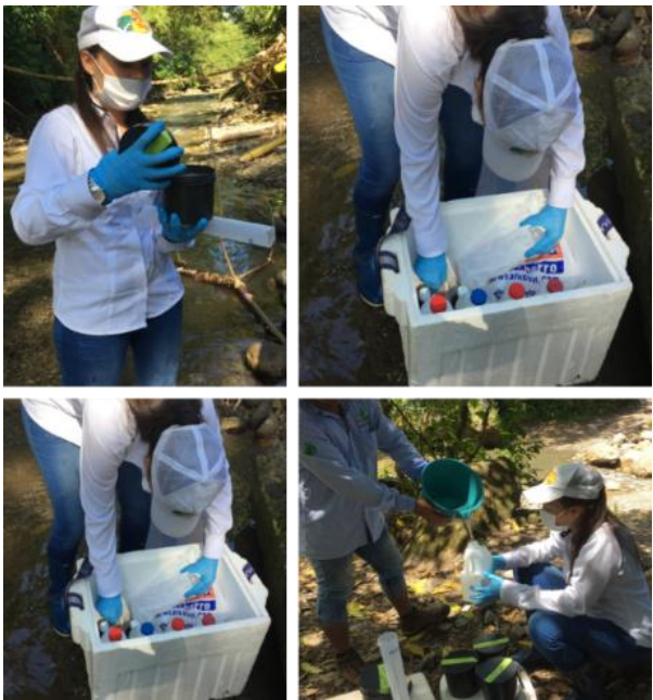
Figura 10. Toma de muestra compuesta en campo. Por Guerrero, 2018
