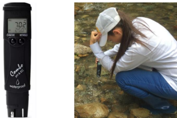
Figura 6. Toma de parámetros Insitu (Temperatura, pH, TDS), con equipo multiparámetro HI98130. Por Guerrero, 2017
