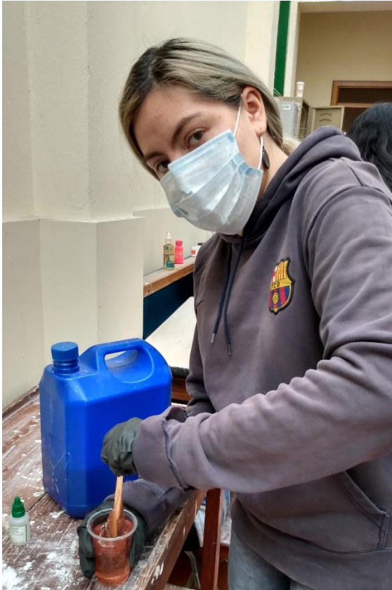
Se mezcla Resina, Catalizador y se corta Fibra de Vidrio
