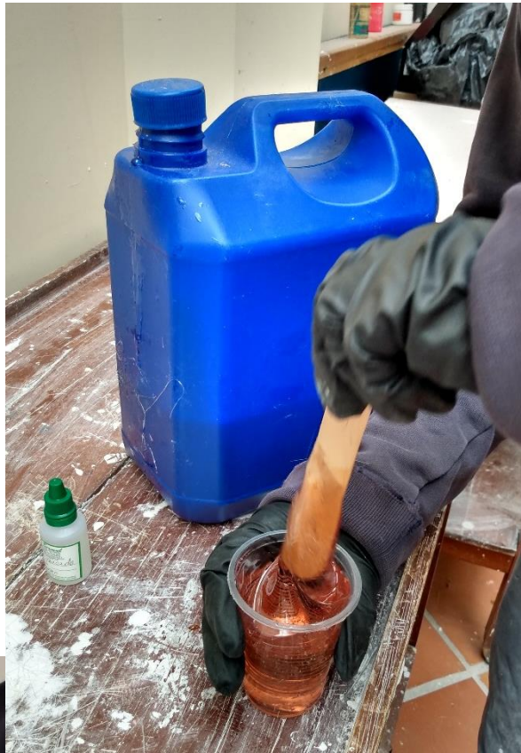
Se mezcla Resina, Catalizador y se corta Fibra de Vidrio
