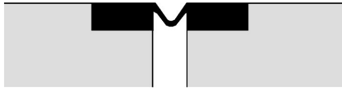
Ilustración 29 Junta de expansión tipo bloque de neopreno
