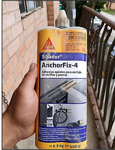
Ilustración 2. Adhesivo epóxico para anclajes
