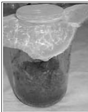
Figura 2. Frasco con tela para la prueba de toxicidad con lombriz de tierra [2].
