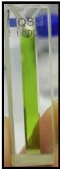
Figura 4. Cubeta con extracto de clorofila post-ensayo, lista para ser medida en espectrofotómetro [2].
