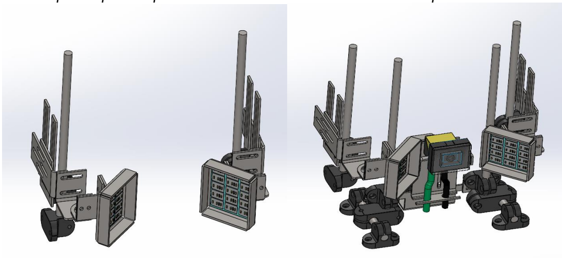
Figura 38. Soportes para implementación de técnica de iluminación difusa
