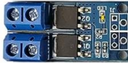
Figura 25. Interruptor de disparo módulo de accionamiento PWM MOSFET
