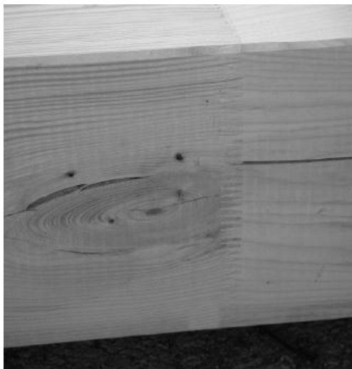
Fig. 30: madera empalmada estructural, tomada de: Manual CONFEMADERA
