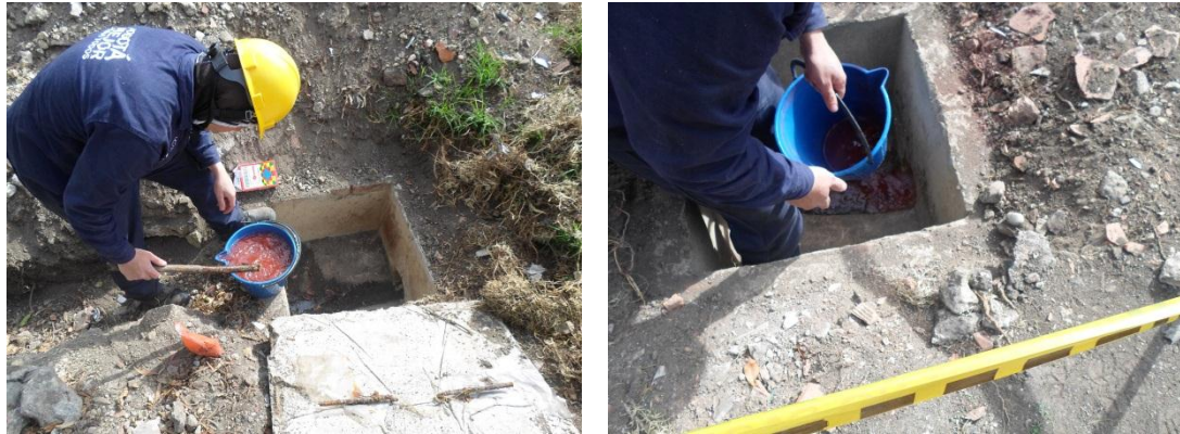
Figura 66.Prueba para verificar redes enterradas/Fuente propia
