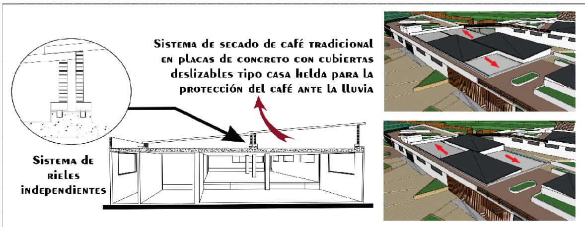
Imagen 22. Detalle de cubiertas tipo casa helda par el secado del café y detalle constructivo de sistema de rieles. Elaboración propia.
