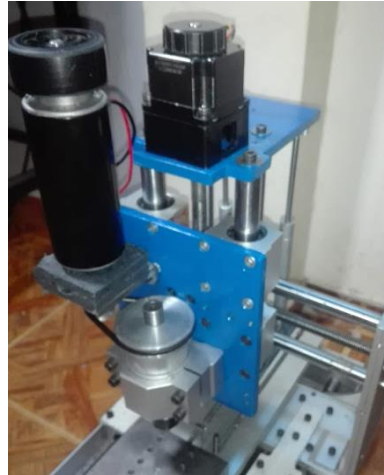
Figura 36. Montaje del husillo y transmisión por polea.
