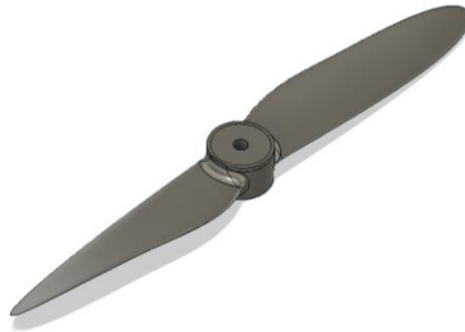
Figura 11. Diseño CAD de la hélice de doble aspa.
