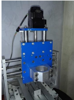
Figura 31. Montaje de la nueva estructura que hace parte del eje vertical (eje z).
