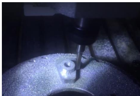
Figura 22. Maquinado en aluminio.
