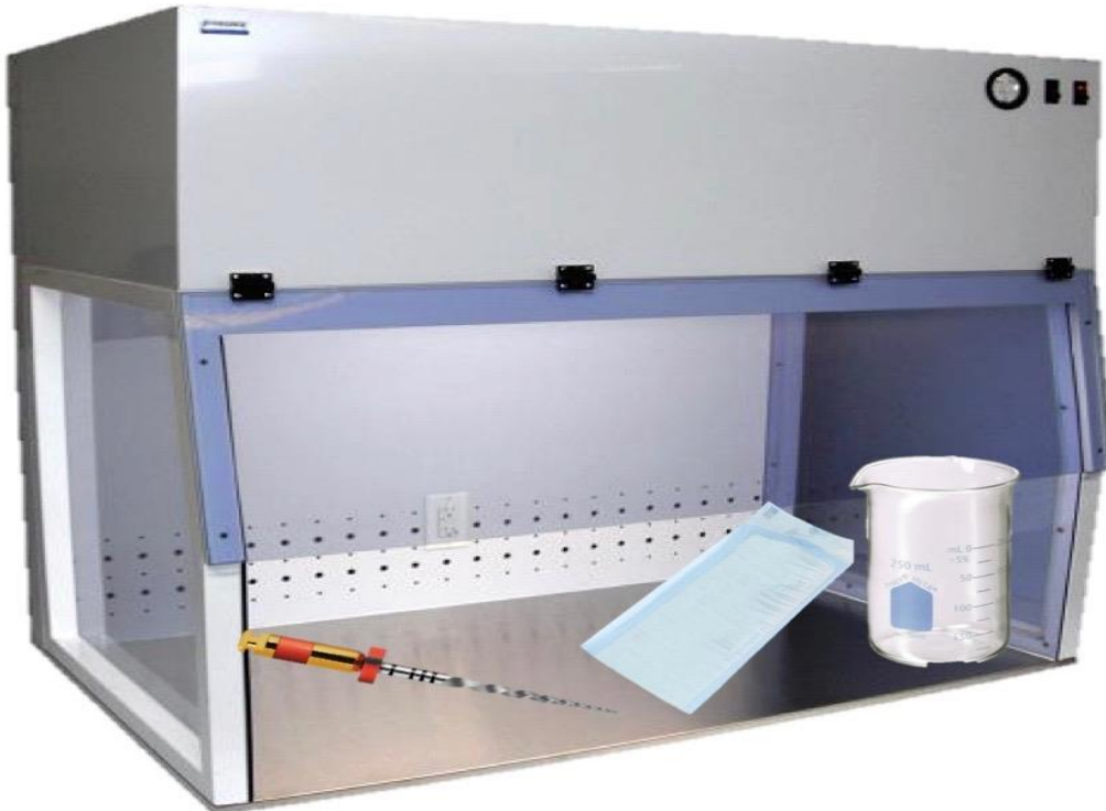
Figura 1 Proceso de preesterilización de las limas en cabina flujo laminar
