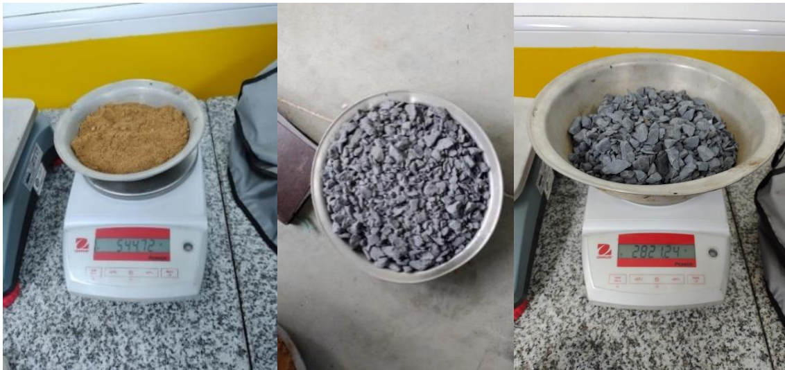
Figura 19. Toma de masa y secado, grava y arena AP
