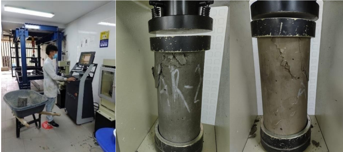
Figura 39. Ensayo de resistencia a la compresión
