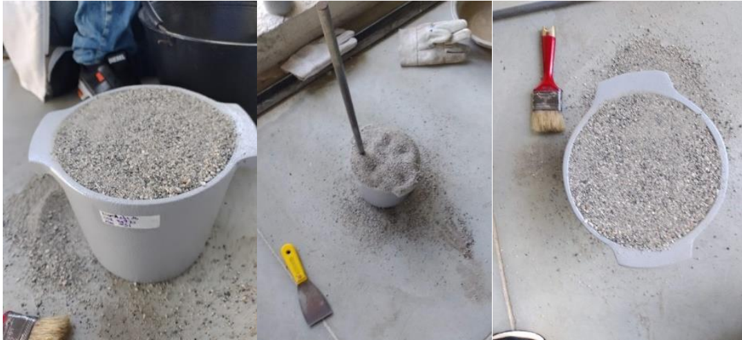
Figura 16. Llenado, compactación y enrazado de la muestra, arena AR
