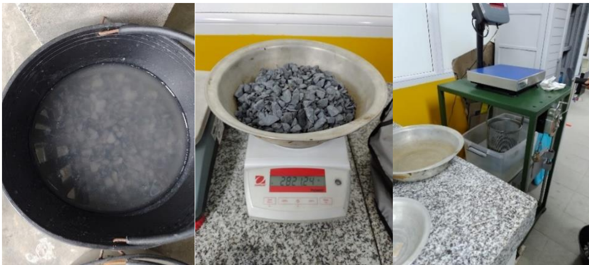
Figura 11. Muestra saturada, seca y masa aparente, grava AP
