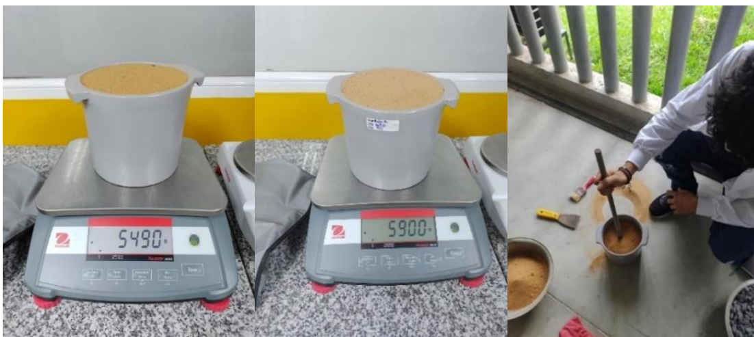
Figura 17. Toma de masa y compactación de la muestra, arena AP
