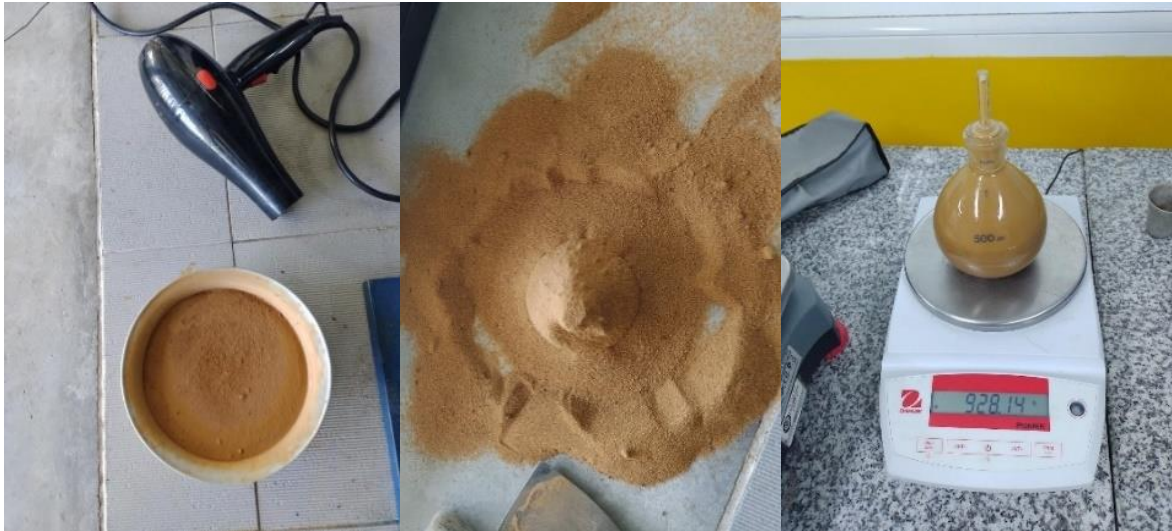
Figura 13. Secado superficial, ensayo del cono y del picnómetro, grava AP
