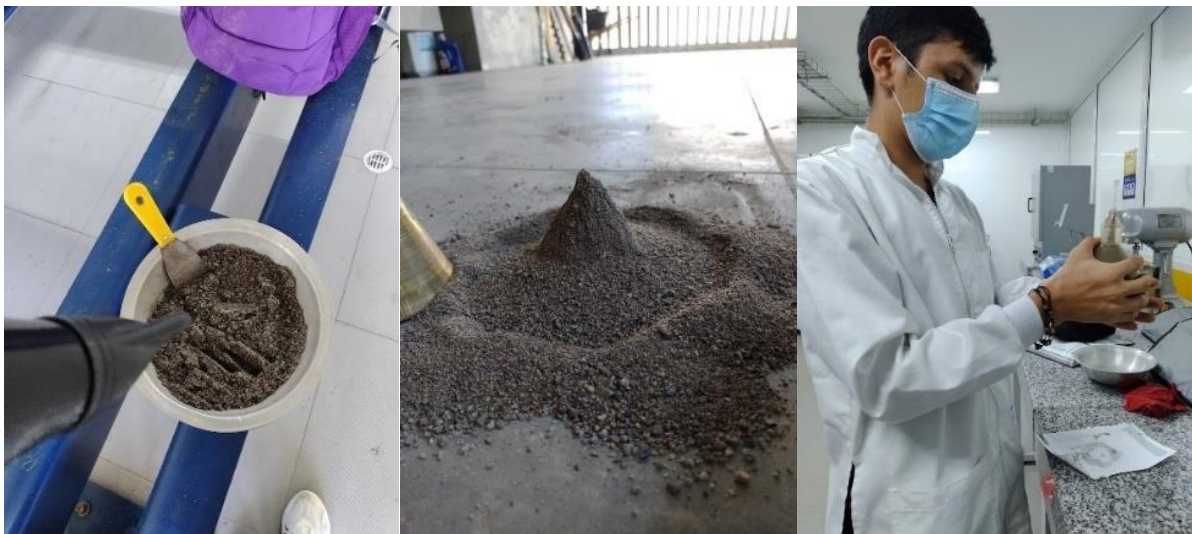
Figura 12. Secado superficial, ensayo del cono y agitación, arena AR
