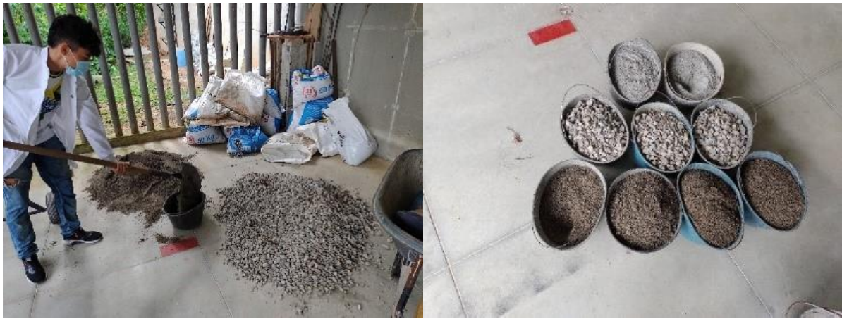
Figura 26. Dosificación de los materiales, concreto CAR
