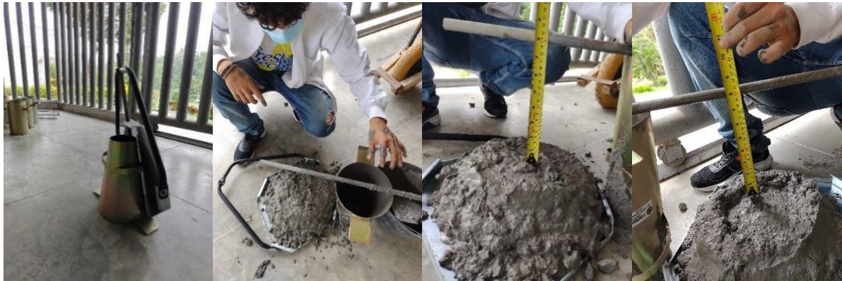
Figura 31. Ensayo de asentamiento, concreto CAR
