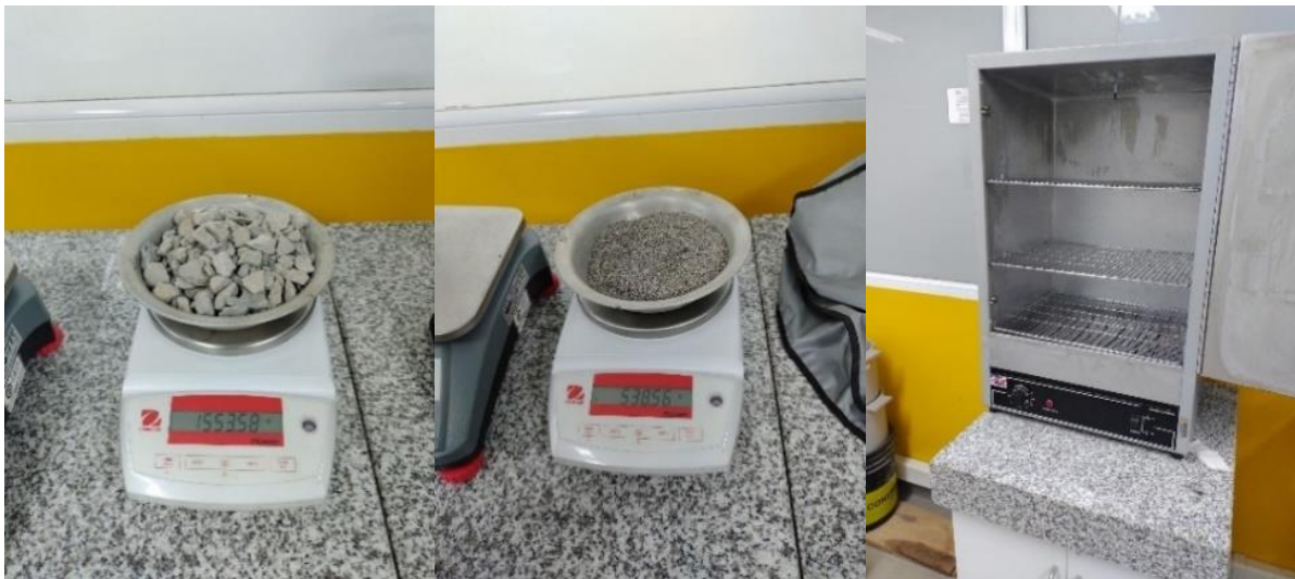
Figura 18. Toma de masa y secado, grava y arena AR
