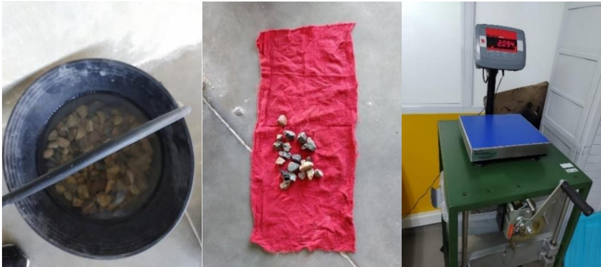
Figura 10. Muestra saturada, seca y masa aparente, grava AR
