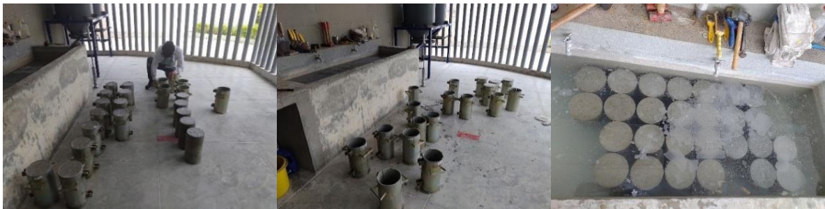
Figura 35. Desencofrado y curado de especímenes, concreto CAP
