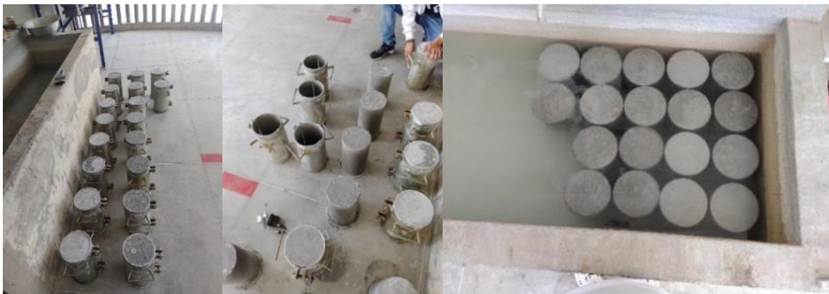
Figura 34. Desencofrado y curado de especímenes, concreto CAR
