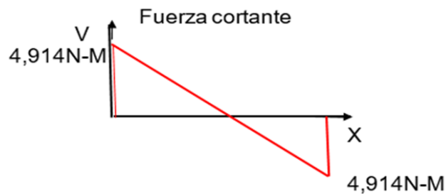
Figura 10: Diagrama Fuerzas Cortantes.
