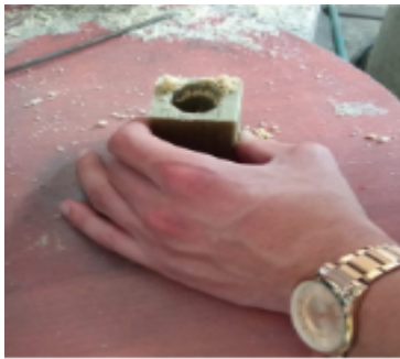
Figura 42: Fabricación de machos.
