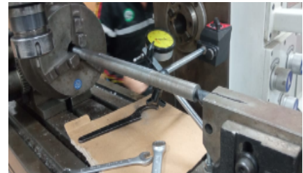
Figura 50: Ajustes para ranurado de chaveta. Figura 51: Ranurado de chaveta.
