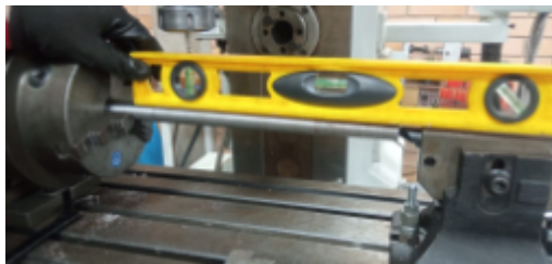
Figura 50: Ajustes para ranurado de chaveta. Figura 51: Ranurado de chaveta.
