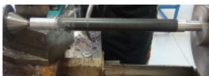
Figura 49: Mecanizado de ejes.
