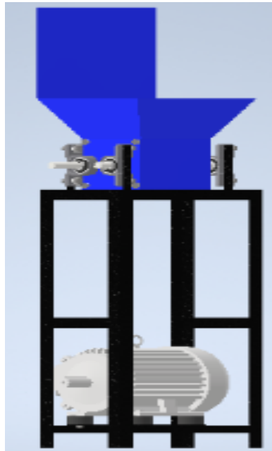
Figura 34: Estructura con motor trifásico.
