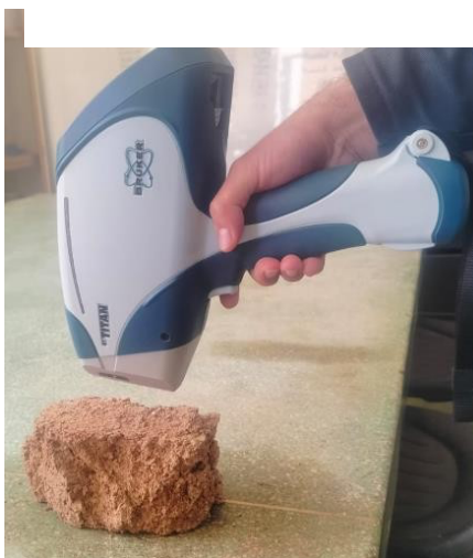
Ilustración 16: Pistola de eflorescencia.
