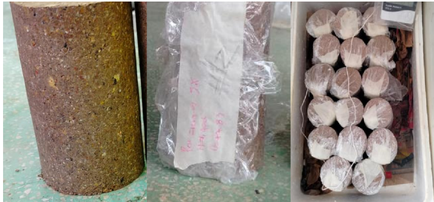
Ilustración 7 Diseño de probetas suelo de cemento (1-3-5-7) % y cámara de curado.
