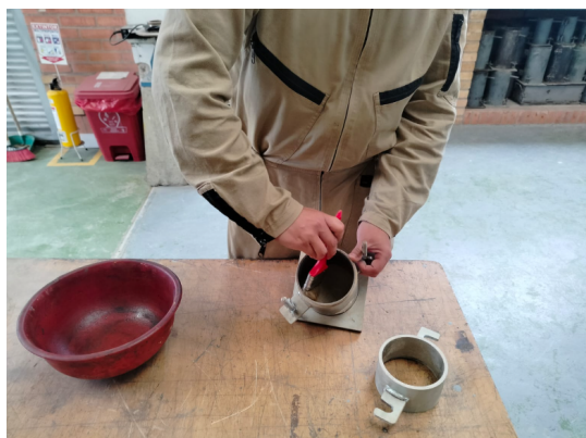
Ilustración 6 humedecimiento de molde con acpm
