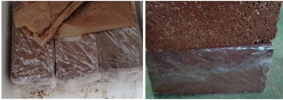
Ilustración 13 Adoquines en cámara de curado por 7 días.
