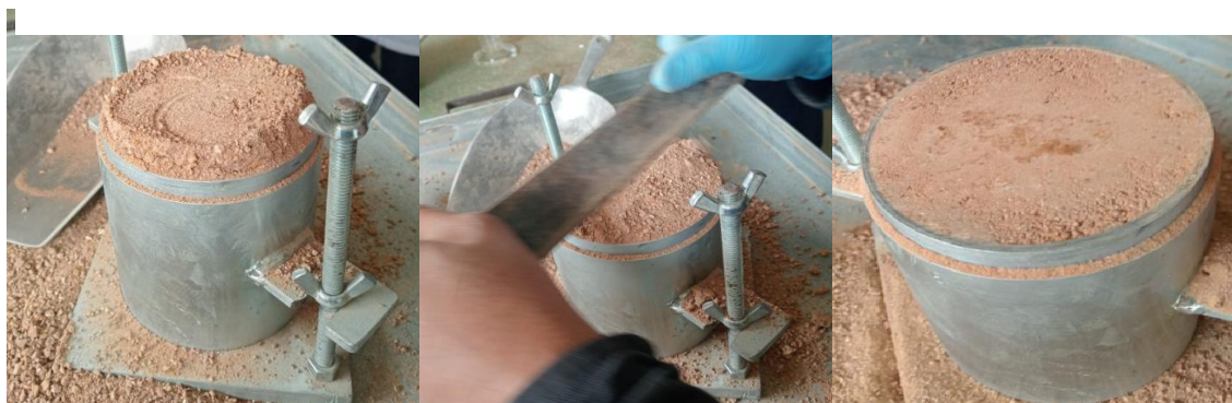
Ilustración 12 : Diseño Proctor estándar del suelo de la formación Tiltatá.
