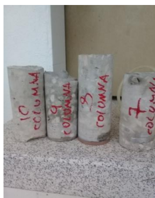
Figura 42. Muestras de Extracción de Núcleos. Fuente: Fotografías del autor.
