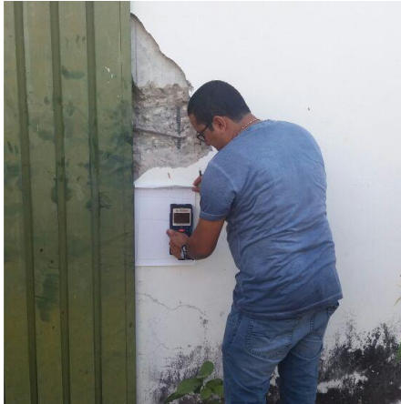
Figura 48. Toma de muestra con escáner de acero. Fuente: Fotografías del autor.
