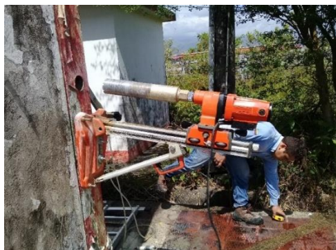
Figura 40. Extractor de núcleos instalados. Fuente: Fotografías del autor.
