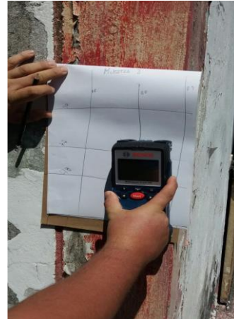
Fotografía 49. Toma de muestra con escáner de acero c-1. Fuente: Fotografías del auto.
