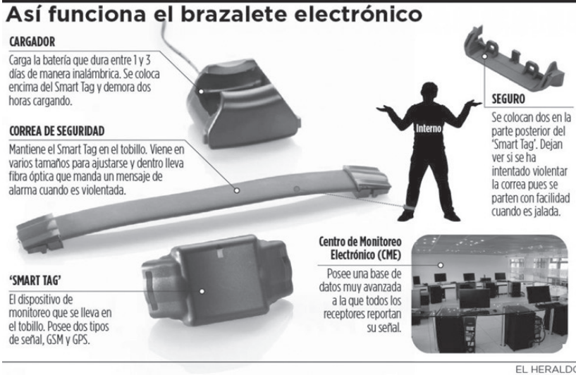
Imagen 3. Funcionamiento de los brazaletes electrónicos en Colombia.
