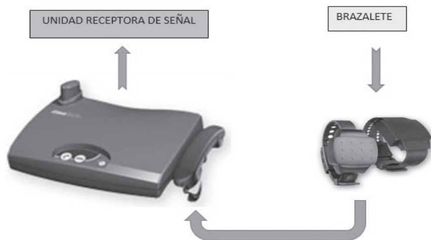
Imagen 2. Unidad de recepción de señal y brazaletes electrónicos utilizados en Colombia.
