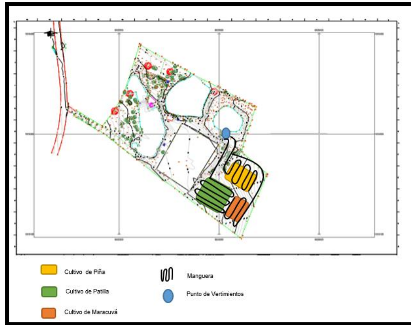
Ilustración 14. Plano de Transporte de Vertimientos a Cultivos
