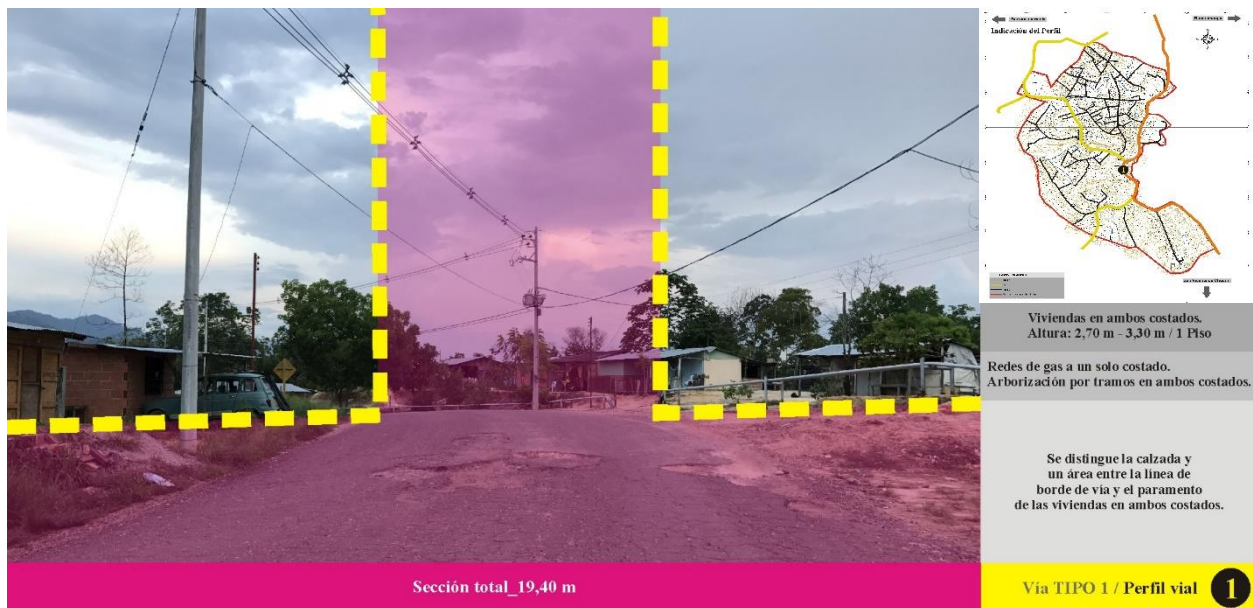
Figura 70. Perfil vial – Vía Tipo 1A.
