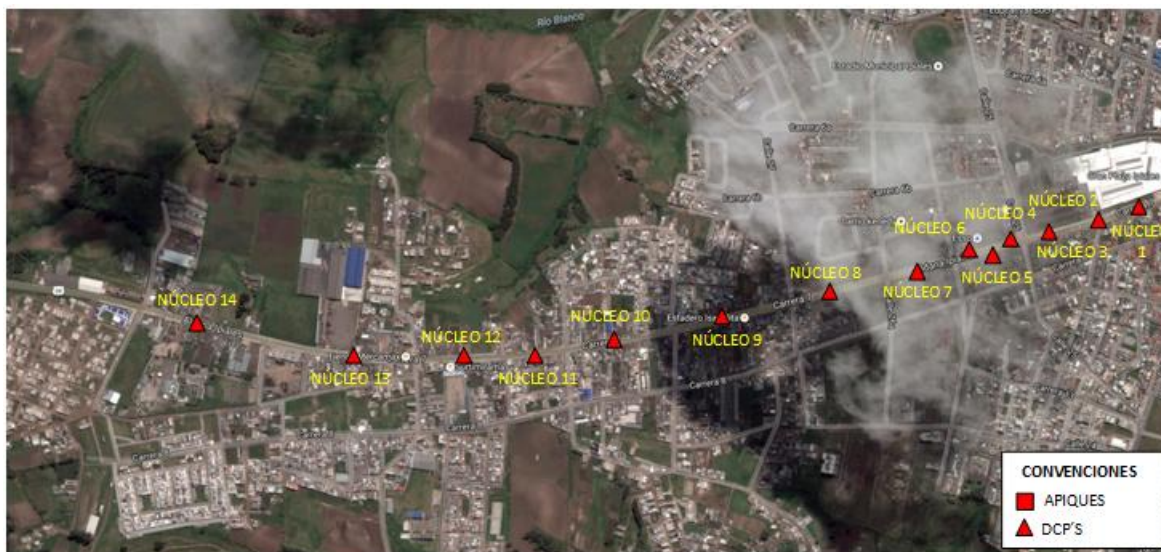
Figura 23. Localización toma de núcleos losa pavimento rígido tramo vial en estudio
