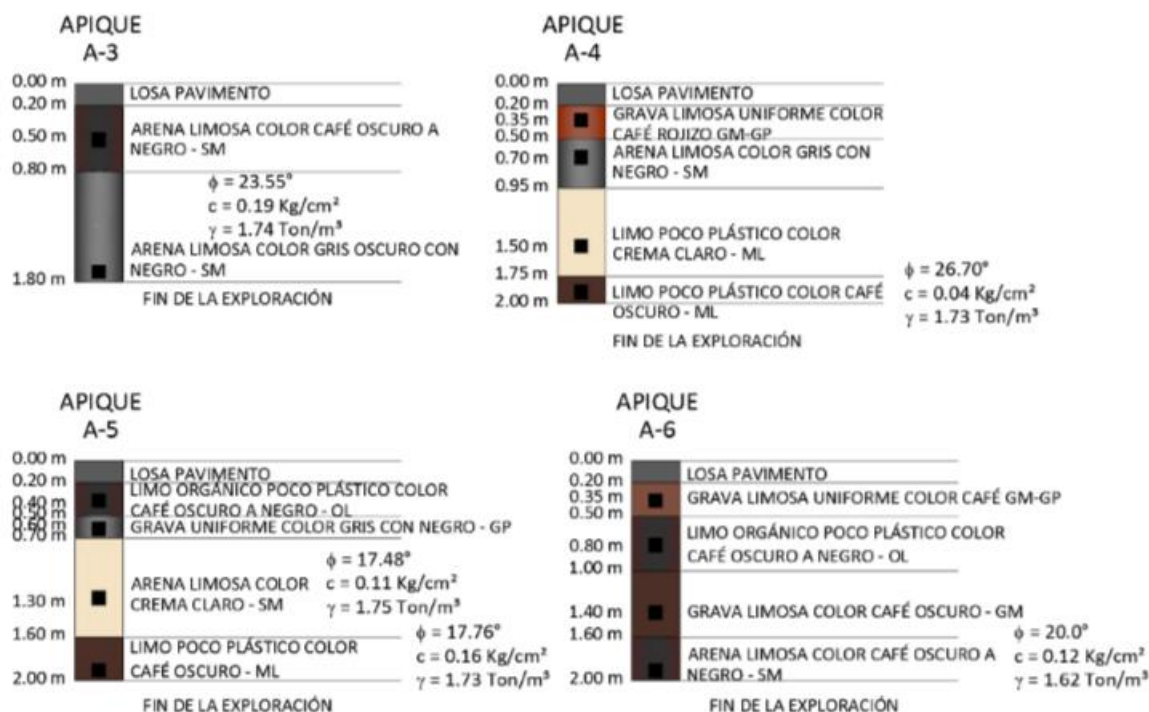
Figura 22. Estratigrafía Apiques A-3 a A-6. Fuente: de este estudio - 2016.
