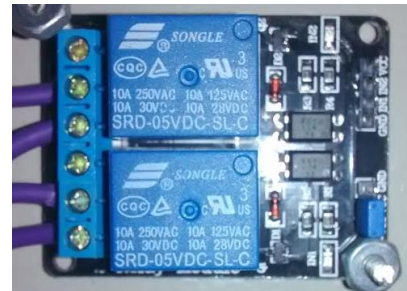
Figura 17 Módulo relay doble Tomado de: AUTOR
