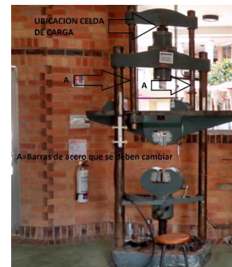
Figura 6 Ubicación celda de carga y barras de acero. Tomado de: AUTOR
