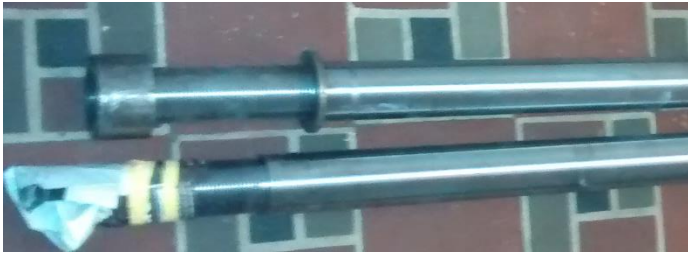
Figura 7 Barras de acero macizo nuevas con maquinado y roscado. Tomado de: AUTOR
