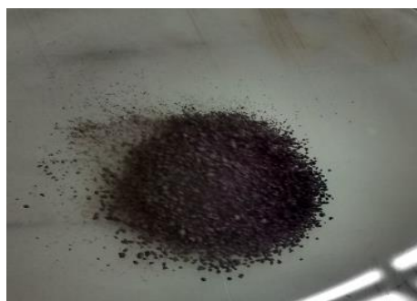
Figura 16. Sólido coloreado obtenido por recrystalización de OPZ en etanol.
