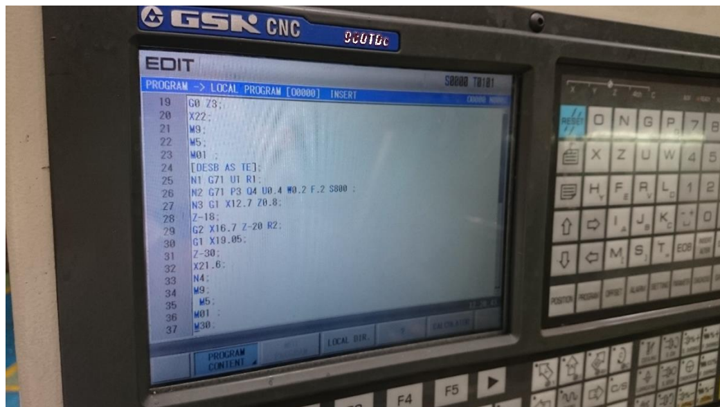
Figura 92. Código Ingresado a la máquina real por USB
