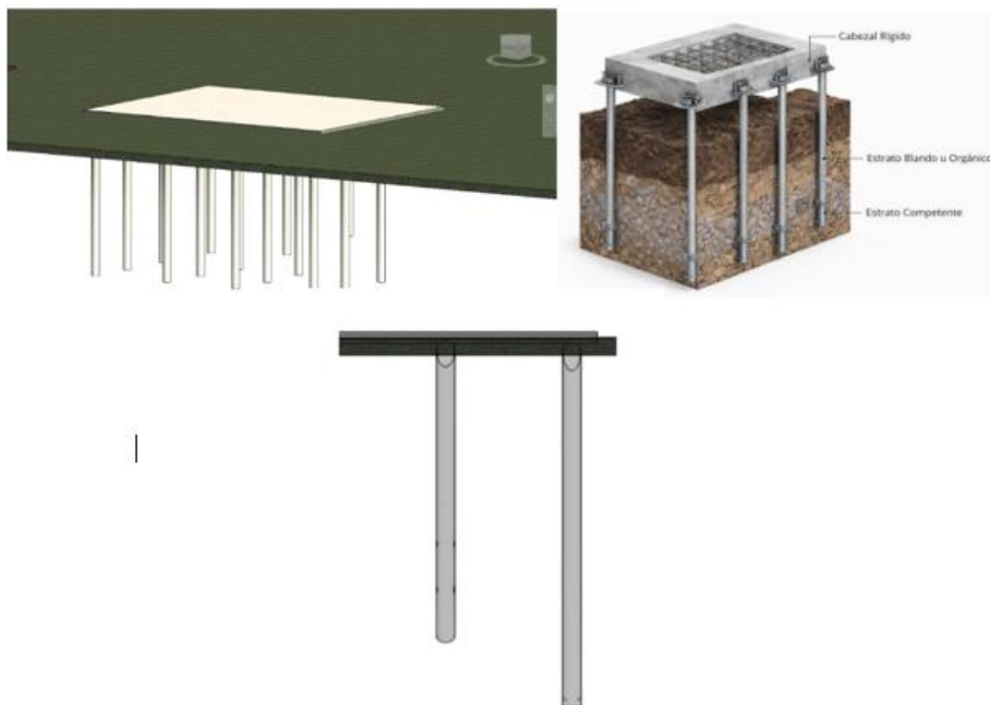
Figura 14. Micropilotes o elementos hincados (sistema profundo)
