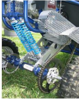
Figura 3-2. Transmisión de potencia por cadenas y piñones. Tomada de [37].
