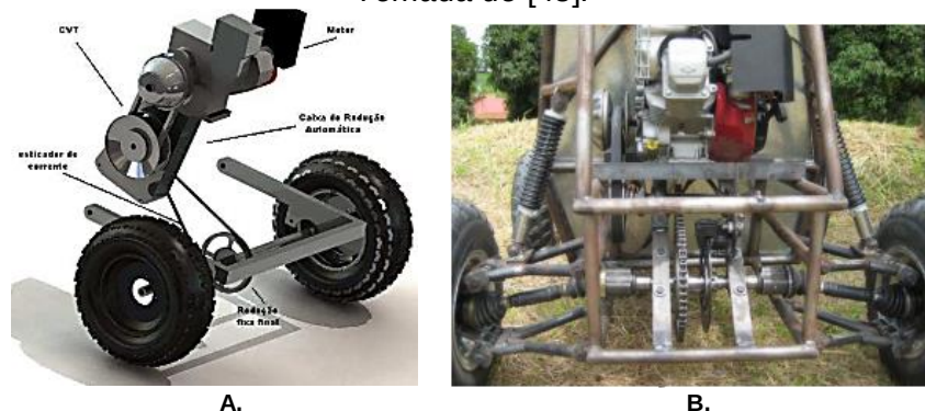
Figura 3-3. Sistema de transmisión con correas: A. Equipo Tomada de [38]. B. Equipo Tomada de [45].
