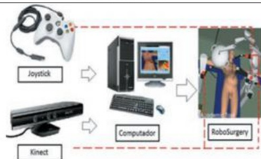
Fig 3. Esquema de componentes para el control de robots por medio de RoboSurgery.
