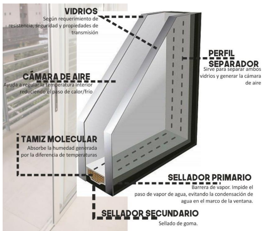
Figura 108. Doble vidrio hermético detalle funcional
