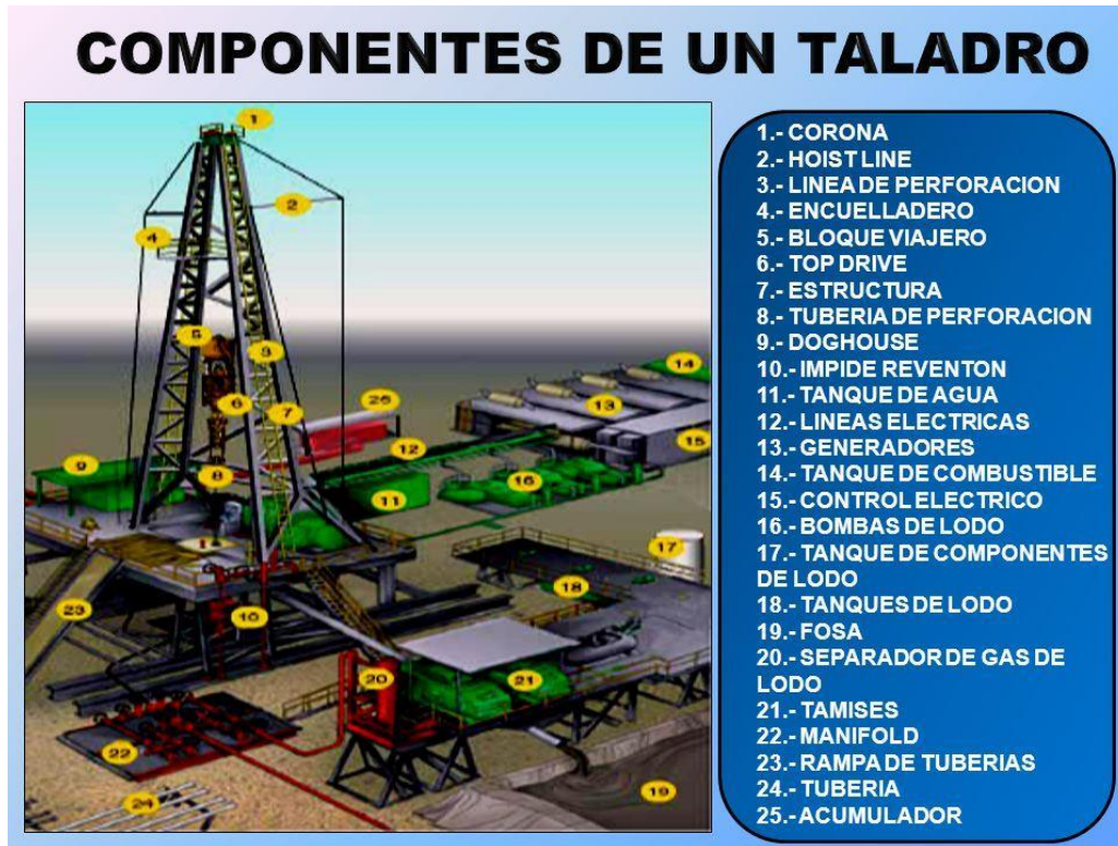
Figura 2. Componentes de un Taladro Fuente: Maquiserpe, 2019.
