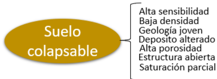
Figura 7 Características típicas de un suelo que es propenso al colapso.
