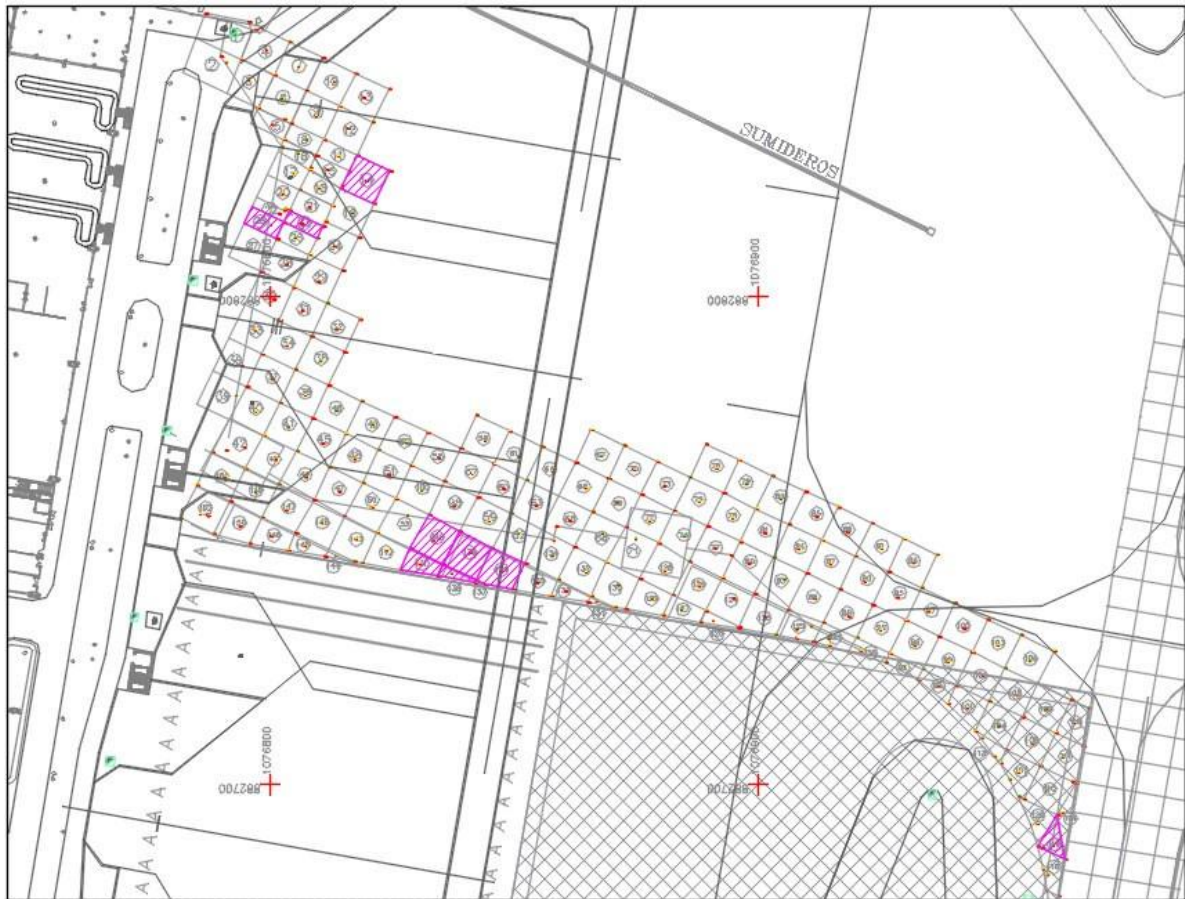
Figura. 24 Localización de placas que presentan grietas longitudinales
