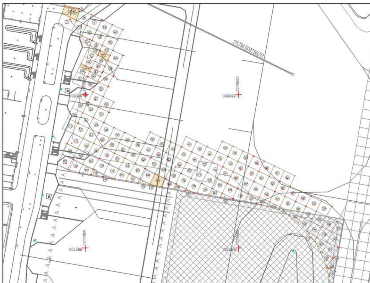
Figura. 26 Localización de placas que presentan grietas transversales
