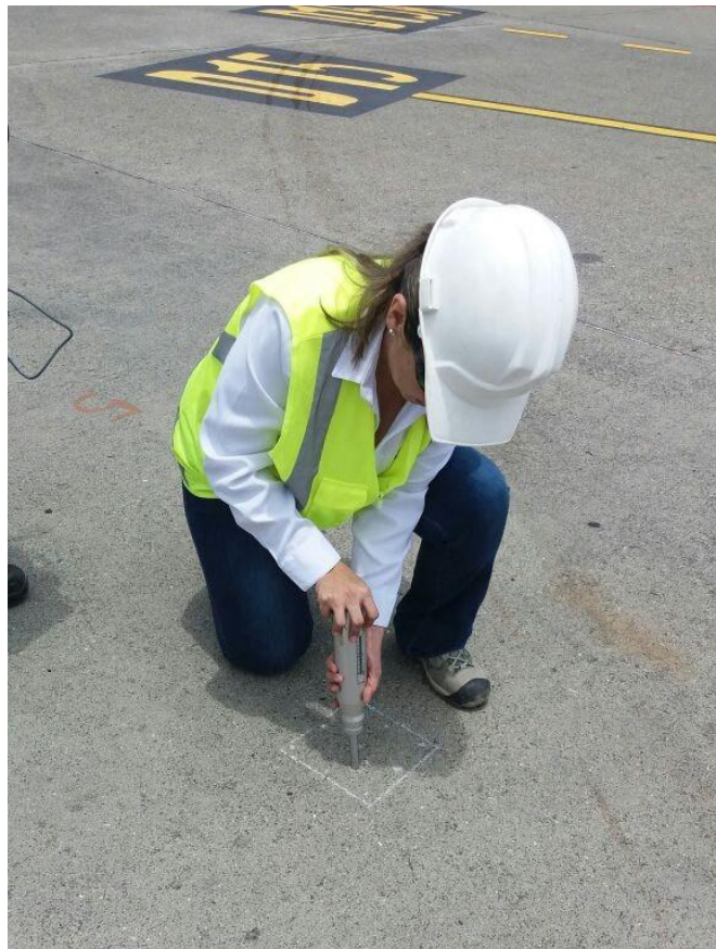
Figura. 39 Arq. Luz Adriana Moreno realizando ensayo de esclerómetro del paciente
