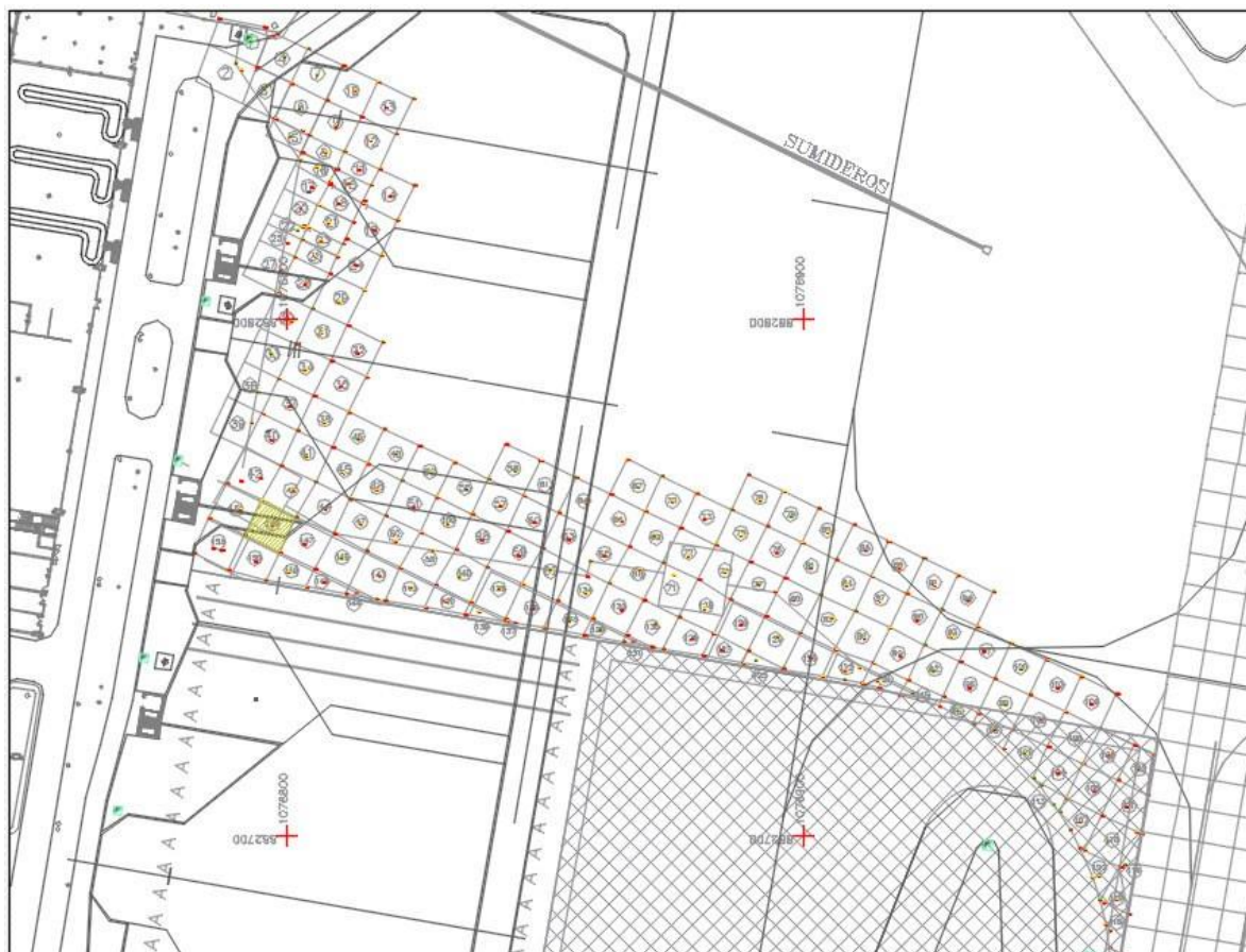
Figura. 32 Localización de placas que presentan baches
