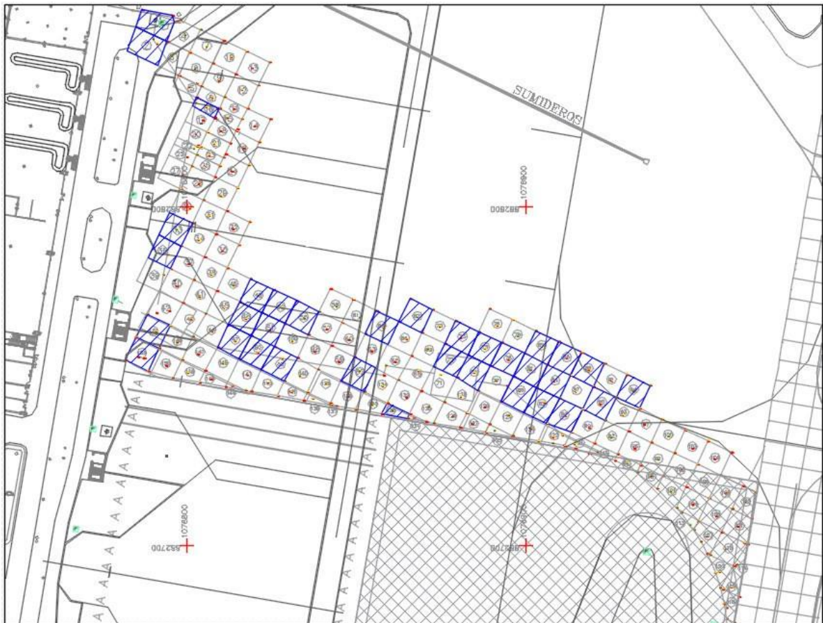
Figura. 28 Localización de placas que presentan descascaramiento
