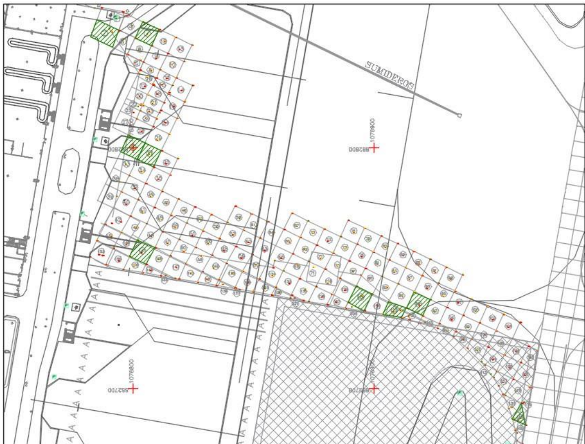
Figura. 36 Localización de placas con fisuración por retracción
