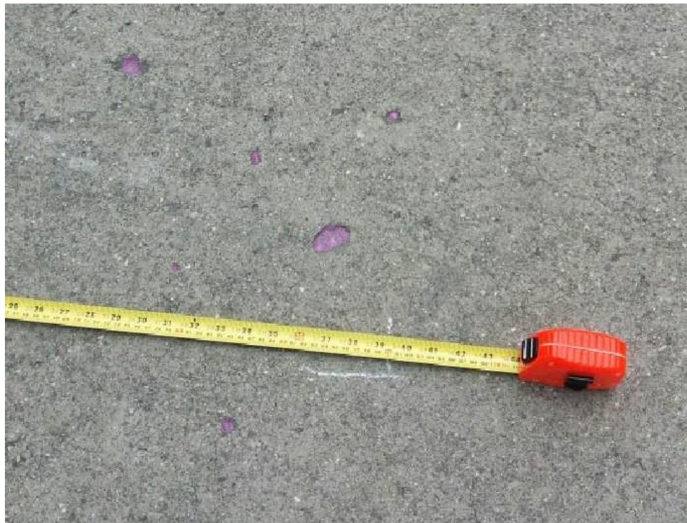
Figura. 41 Prueba con fenolftaleína
