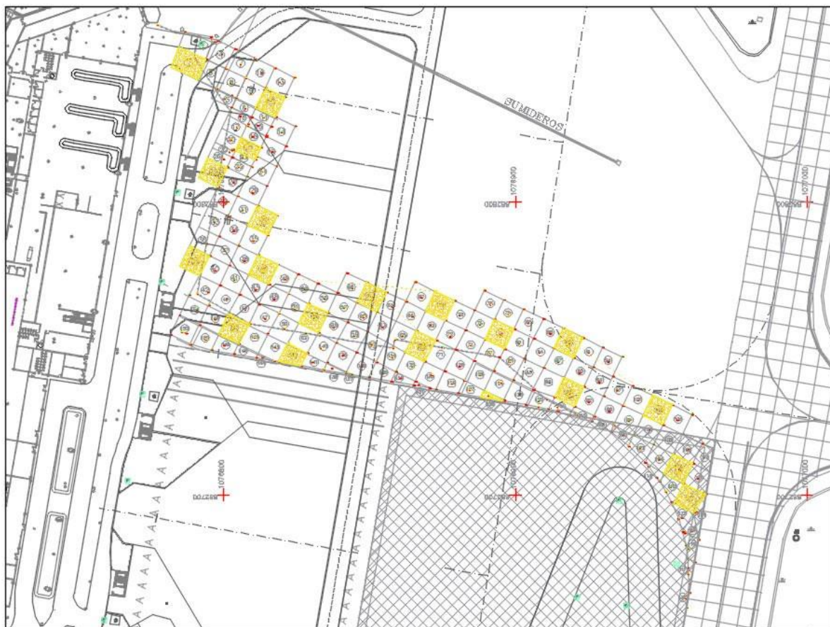
Figura. 40 Localización de placas a las que se les realizó el ensayo de esclerómetro
