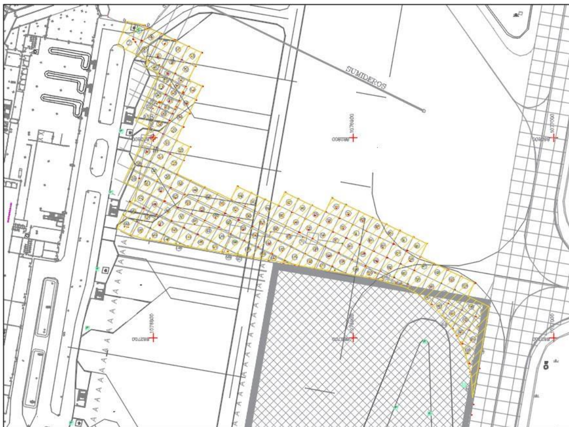
Figura. 18 Localización de placas que tienen deficiencia en el sellado de las juntas
