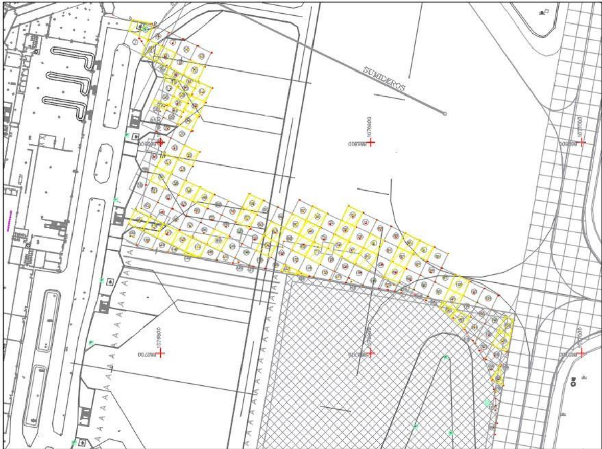
Figura. 20 Localización de placas que tienen desportillamiento en las juntas
