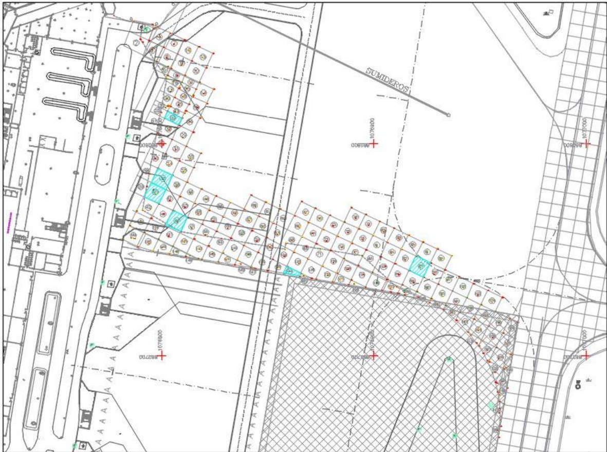
Figura. 22 Localización de placas que presentan grietas de esquina
