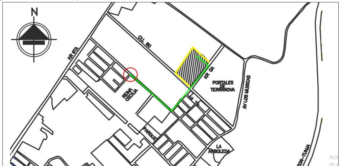
Figura 9. Zona de empalme red de acueducto.
