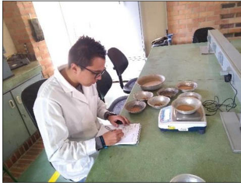
Figura 23. Toma de datos-Ensayo de Granulometría.
