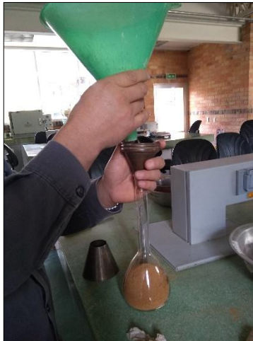
Figura 25. Vertido del material al matraz - Gravedad específica.
