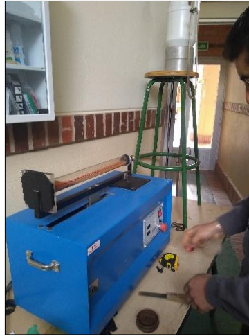
Figura 21. Mezclado en el agitador mecánico-Equivalente de Arena.
