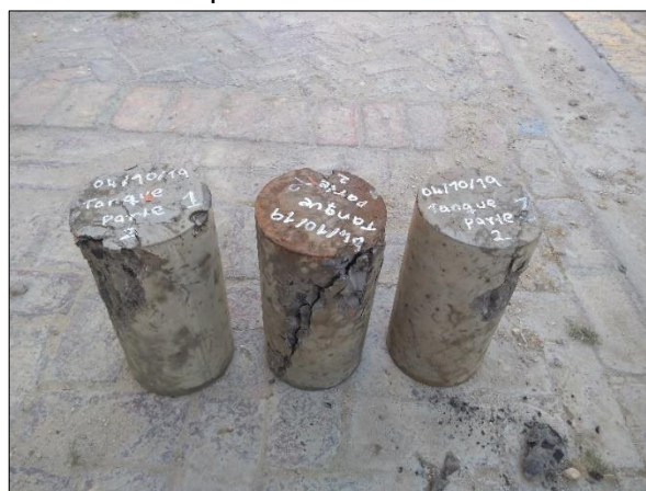
Figura 27. Muestras de concreto después de la falla.
