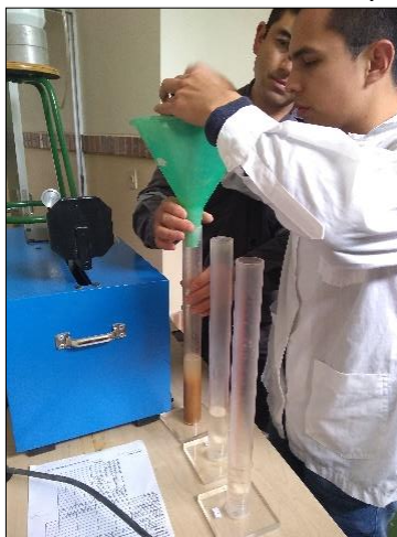
Figura 20. Aplicación de la muestra en solución Stock-Equivalente de arena.
