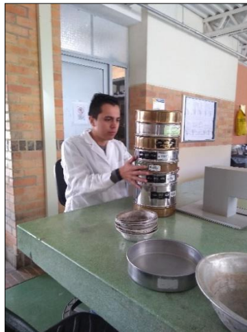
Figura 22. Tamizado del material-Ensayo de Granulometría.
