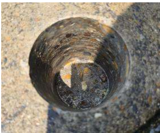
Ilustración 60. Orificio Extracción Núcleo No1.
