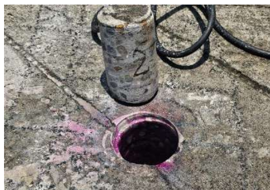
Ilustración 54. Núcleo No 2 Extraído.
