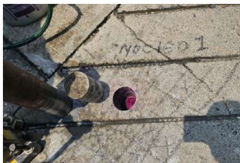
Ilustración 50. Núcleo No 1 Extraído.
