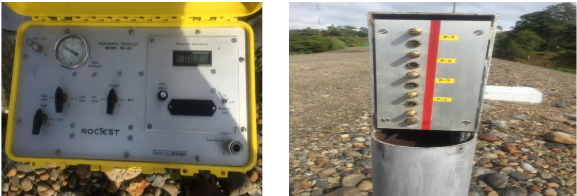
Imagen 10. Unidad Portátil de recolección de datos y Punto Terminal
