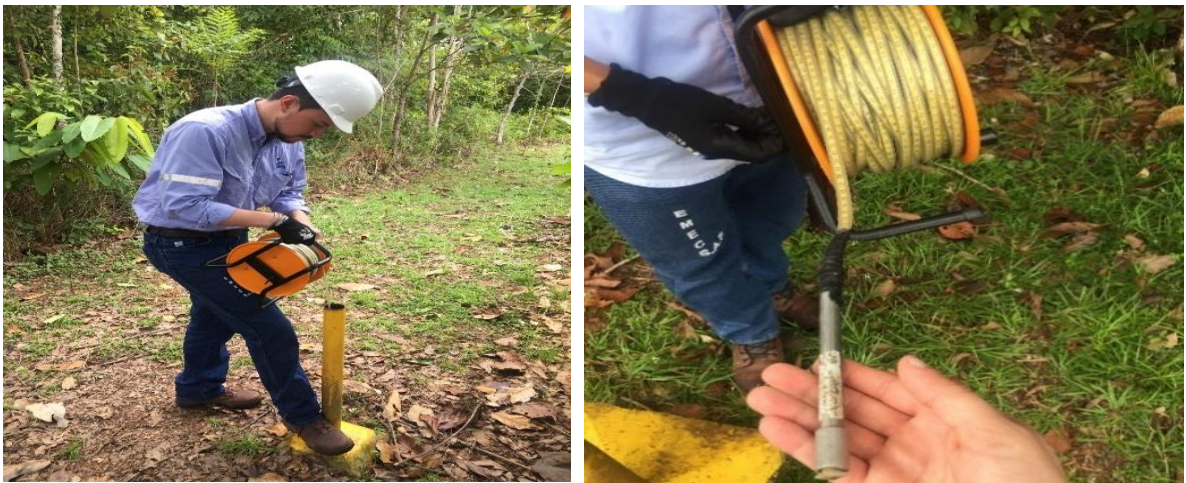
Imagen 5. Toma de datos de Piezómetro de Tubo Abierto.
