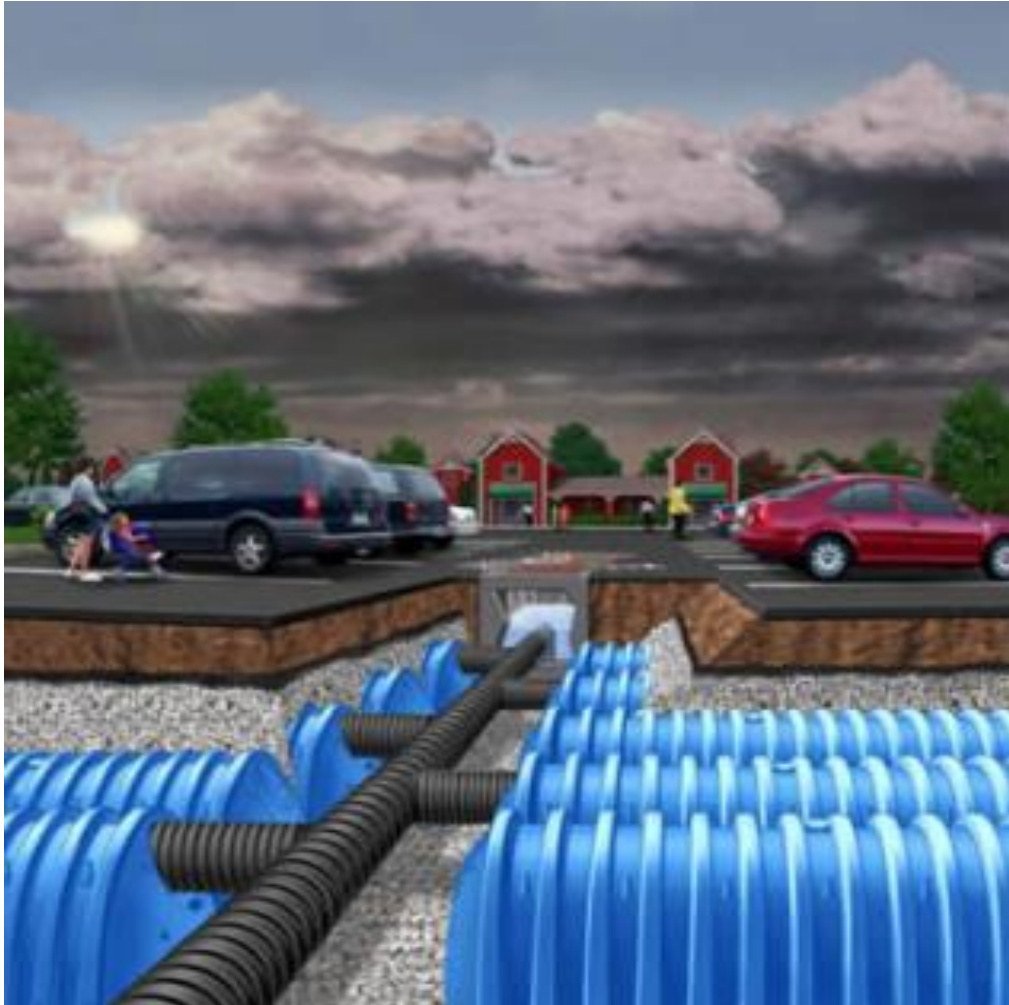
Figura 3. Imagen Sistema Drenatura StormTech. Nota: Stormtech de Drenatura. Fuente: http://www.drenatura.com/aguas-pluviales-infiltracion-stormtech.html#/?playlistId=0&videoId=0
