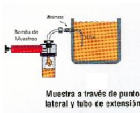
Figura 18. Método de toma de muestras aceite a través de un grifo.
