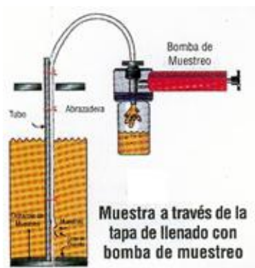
Figura 16. Método de toma de muestras aceite por medio de una bomba.
