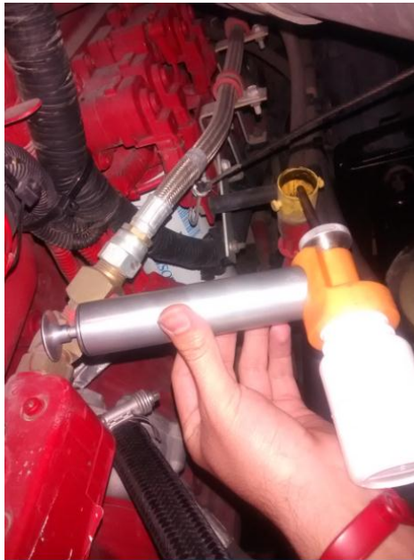
Figura 17. Método real del procedimiento de toma de muestras por medio de una bomba utilizado en un vehículo.
