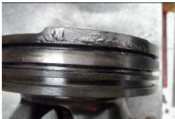
Figura 7. Carbonamiento de la corona del pistón a causa del combustible no quemado.
