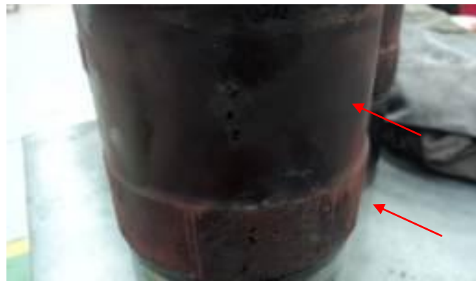
Figura 3. Cavitación mostrada en una camisa de un motor diesel.
