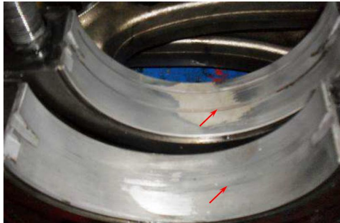
Figura 10. Daño a casquetes por aceite contaminado con sílice (tierra).
