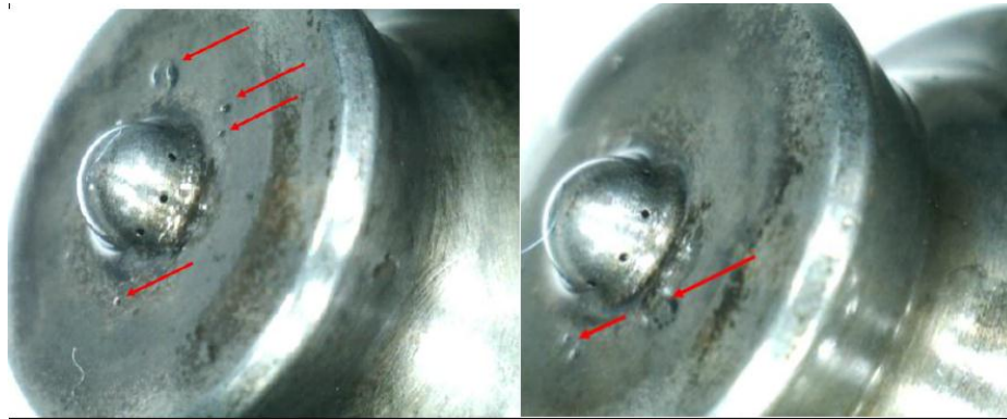
Figura 2. Evidencia de erosión en la punta de los inyectores debido a la incorrecta pulverización del combustible.
