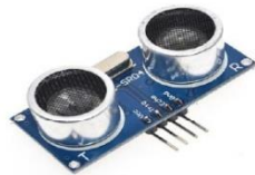
Figura 1. Sensor ultrasónico HC-SR04 [5]
