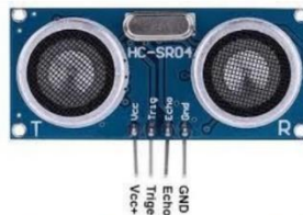
Figura 2. Distribución de pines - Sensor Ultrasónico [5]
