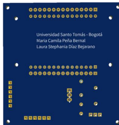
Figura 63. Vista 3D inferior del diseño PCB del módulo principal. Fuente: Autoras.
