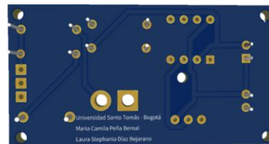
Figura 18. Vista 3D inferior del diseño PCB del módulo infrarrojo. Fuente: Autoras
