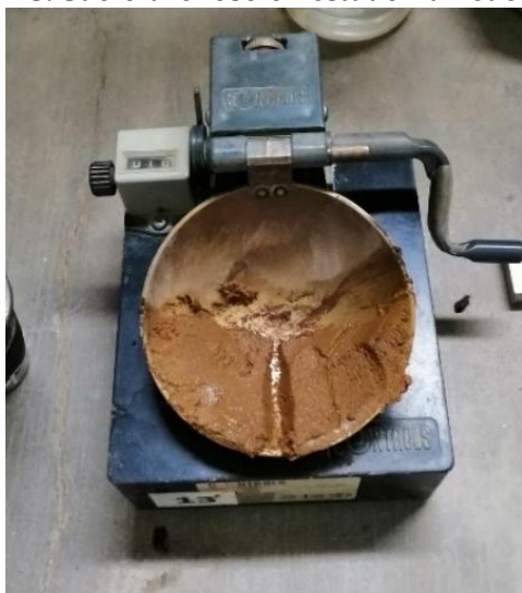
Figura 18. Suelo arenoso en estado húmedo en la cazuela de Casagrande
