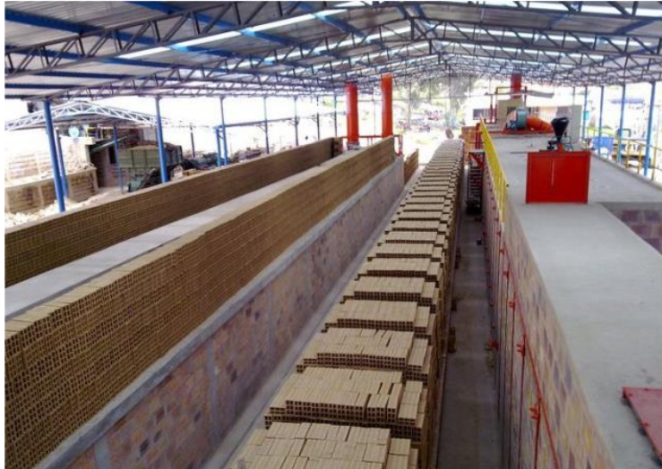
Figura 14: Zona de secado natural. Ladrillera fénix
