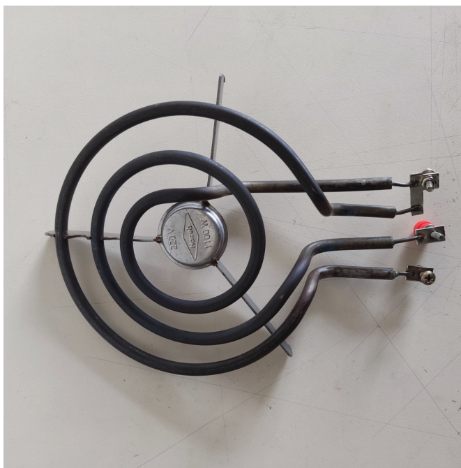
FIGURA 31: Elemento resistivo para emulación de carga no crítica 2. Tomado de: Autores.
