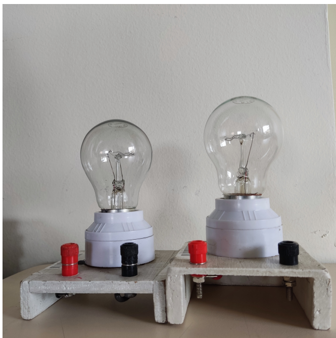
FIGURA 30: Elemento resistivo para emulación de carga no crítica 1. Tomado de: Autores.
