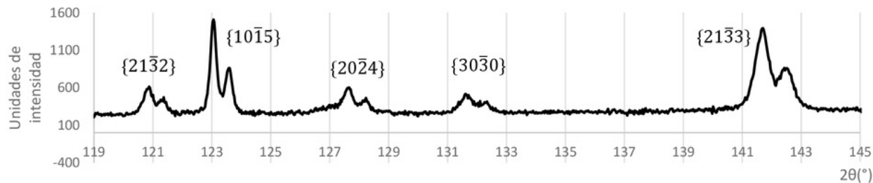
Figura 5. Familias de planos cristalográficos para ángulos mayores a 120^\circ en la aleación Ti-6AL-4V. Fuente: Autores.
