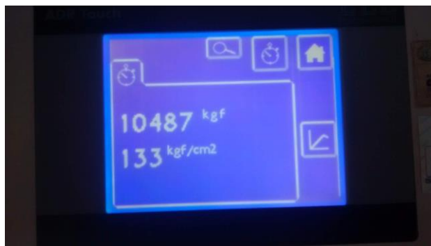
Figura 23. Prueba de compresión cilindro N°1 edad 7 días. Fuente: autor
