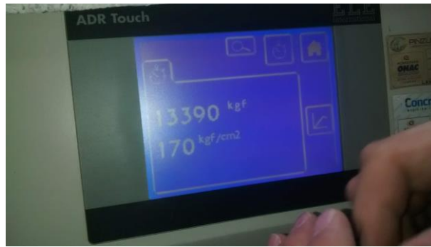
Figura 24. Prueba de compresión cilindro N°2 edad 14 días. Fuente: autor
