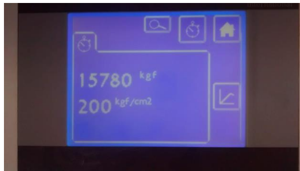
Figura 25. Prueba de compresión cilindro N°3 edad de 28 días. Fuente. Autor
