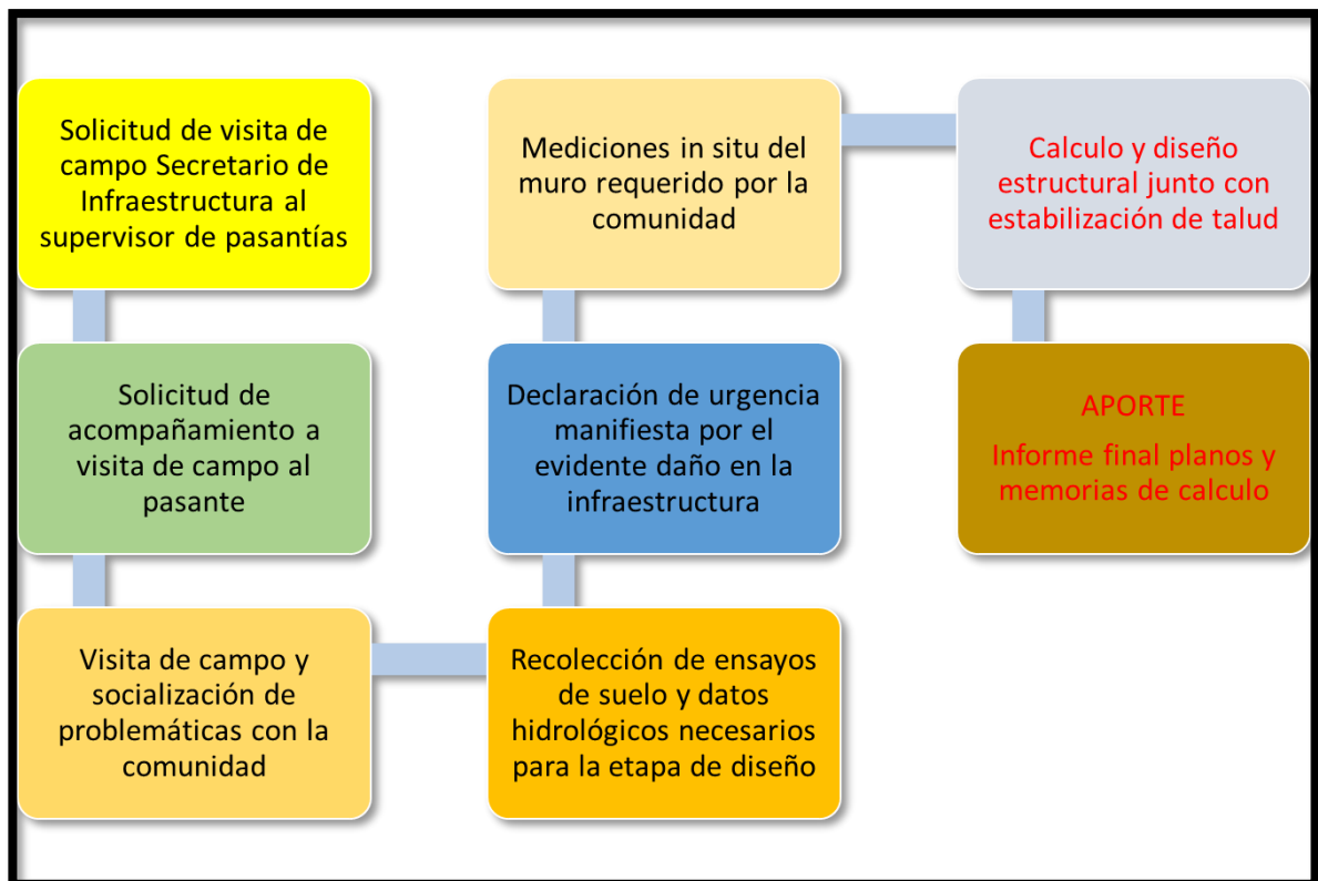
Figura 7. Mapa de proceso de actividades muro de contención barrio Santa Inés. Fuente. Autor
