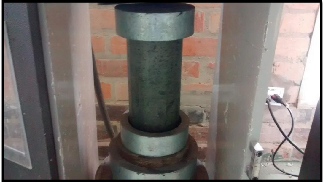
Figura 22. Prueba de compresión laboratorio de concretos Universidad Santo Tomas Tunja. Fuente. Autor
