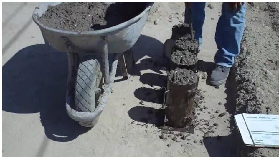
Ilustración 14 Toma de muestras concreto (foto de ejemplo) “www.youtube.com1280 × 720Buscar por imágenes”
