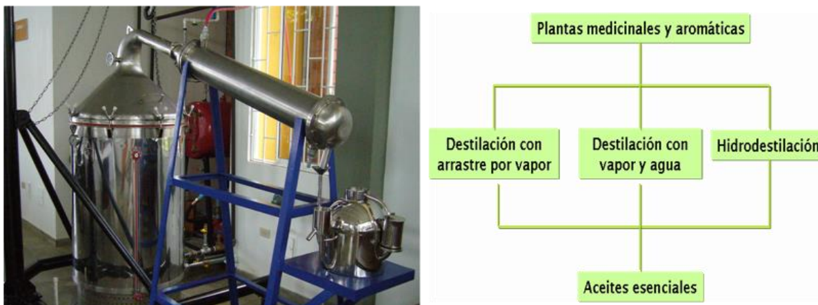
Figura 3. Métodos destilativos para la obtención de aceites esenciales.
