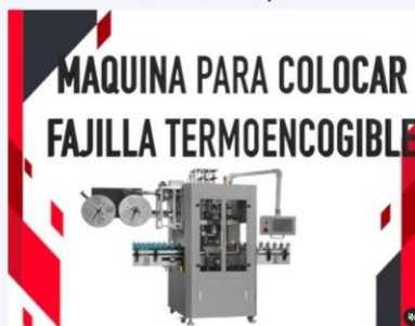
Máquina para colocar fajilla a los envase y Tunnel para termoencoger
