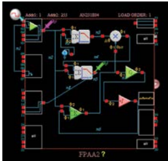
Figura 33. Implementación circuito variador
